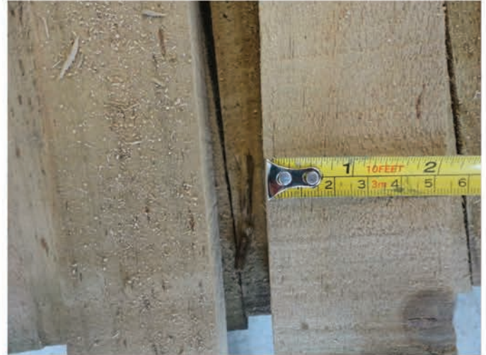
Control de tolerancias dimensionales.
