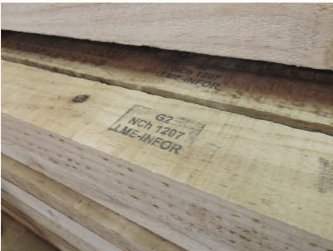
Piezas de madera con timbre estructural G2.
