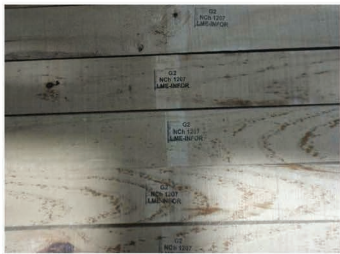
Todas las piezas clasificadas en el grado estructural G2 o mejor fueron timbradas para facilitar su trazabilidad durante el desarrollo del proyecto.
