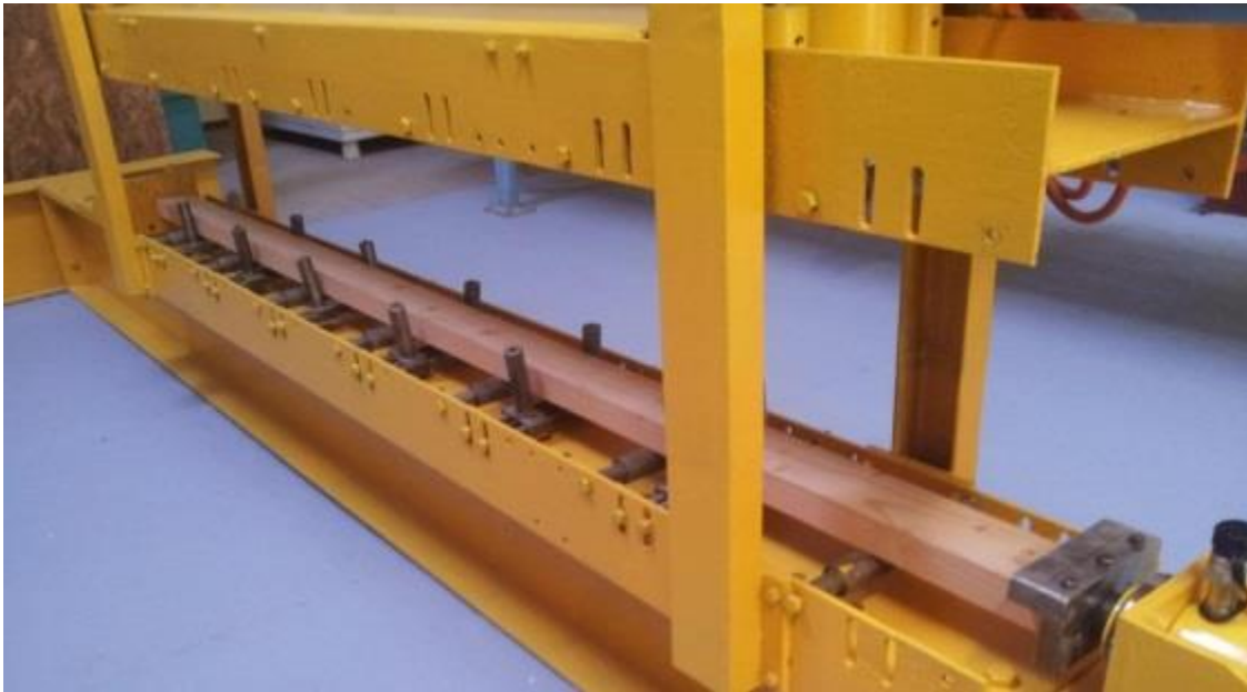
Figura N° 6 APLICACIÓN ENSAYO RESISTENCIA A LA COMPRESIÓN PARALELA A LAS FIBRAS EN LME-INFOR
