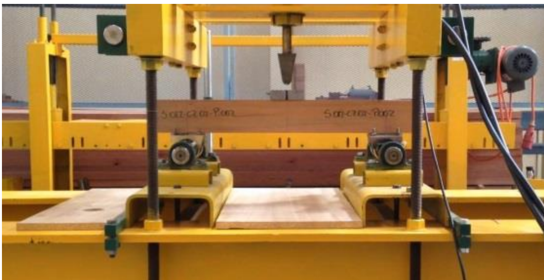
Figura N° 8 APLICACIÓN ENSAYO DE RESISTENCIA AL CIZALLE PARALELO A LAS FIBRAS EN LME-INFOR
