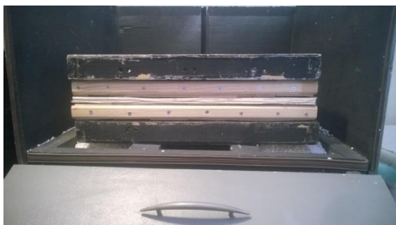
Figura N° 13 DISPOSICIÓN DE LAS PROBETAS PARA EL ENSAYO DE CONDUCTIVIDAD TÉRMICA
