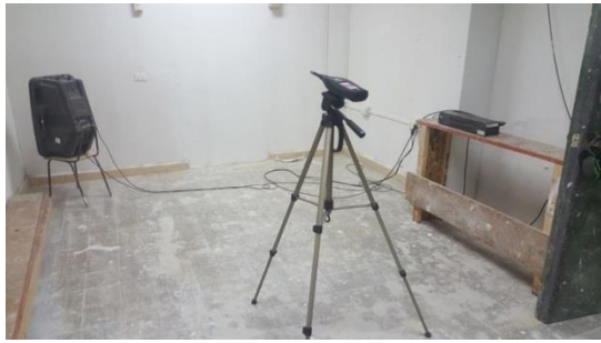
Figura N° 5 IMPLEMENTACIÓN DEL ENSAYO DE AISLACIÓN ACÚSTICA EN SALA EMISORA
