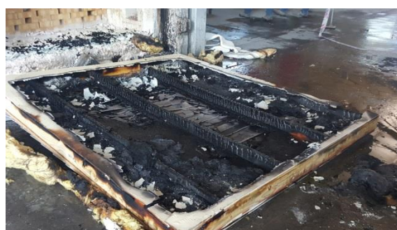
Figura N° 18 CARA EXPUESTA AL FUEGO POSTERIOR AL ENSAYO (41x90 mm)
