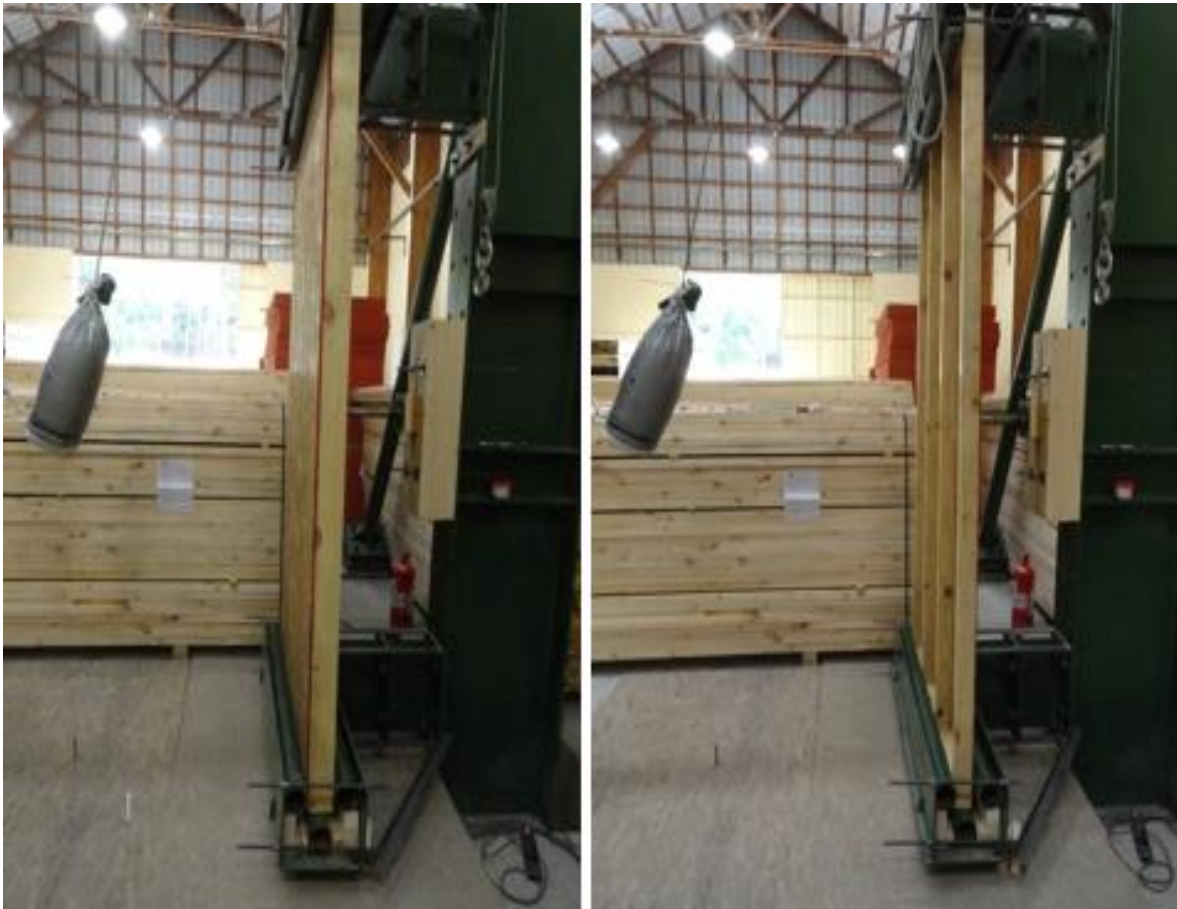
Figura N° 4 APLICACIÓN ENSAYO IMPACTO EN CARA FRONTAL (OSB) Y POSTERIOR EN LME-INFOR
