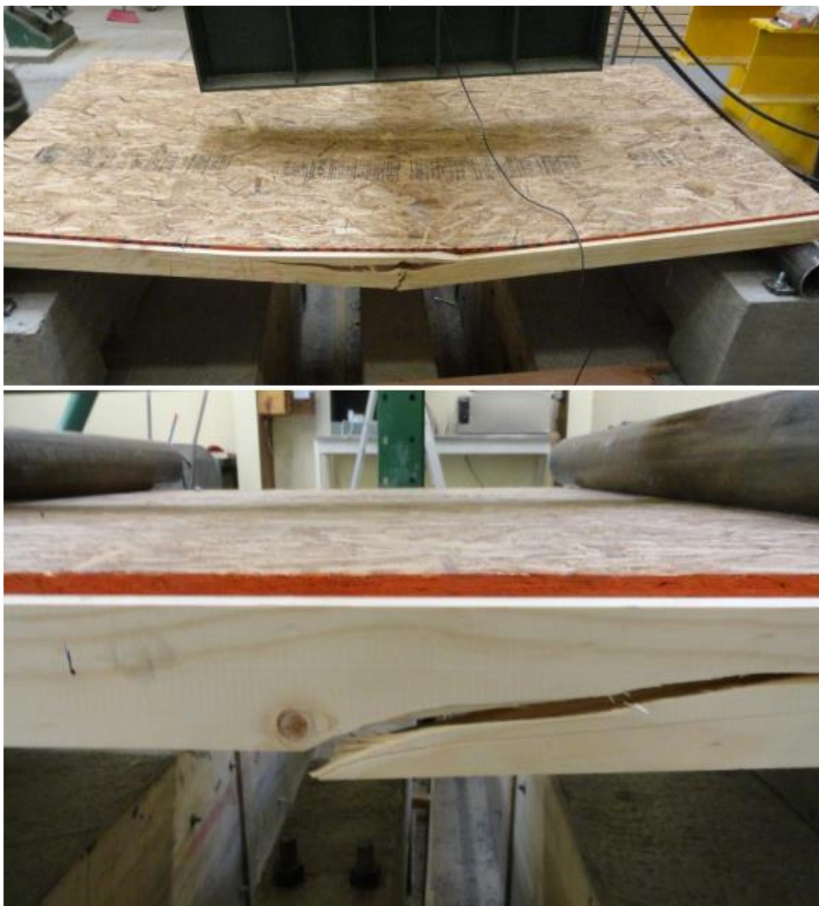
Figura N° 18 FALLA ENSAYO DE FLEXIÓN EN MUROS. CARGA APLICADA EN LA CARA ARRIOSTRANTE EN LME-INFOR
