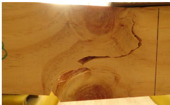
Figura N° 14 FALLA TÍPICA POR CIZALLE INFLUENCIADA POR LA PRESENCIA DE NUDOS
