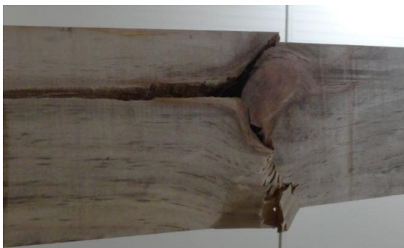
Figura N° 13 FALLA DE COMPRESIÓN INDUCIDA POR LA PRESENCIA DE NUDOS
