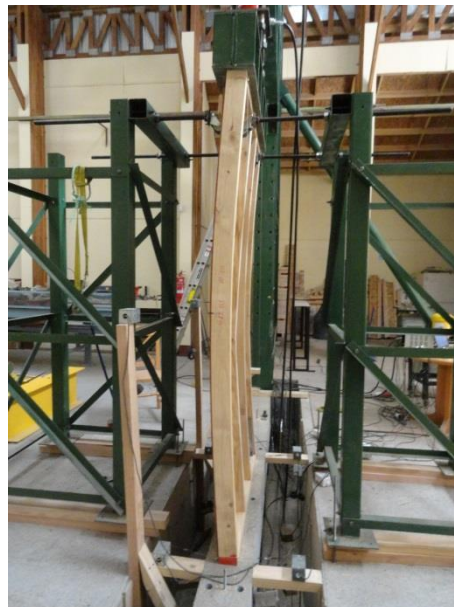
Figura N° 1 APLICACIÓN ENSAYO CARGA VERTICAL EN LME-INFOR
