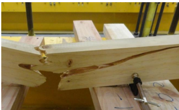
Figura N° 11 FALLA TÍPICA POR FLEXIÓN
