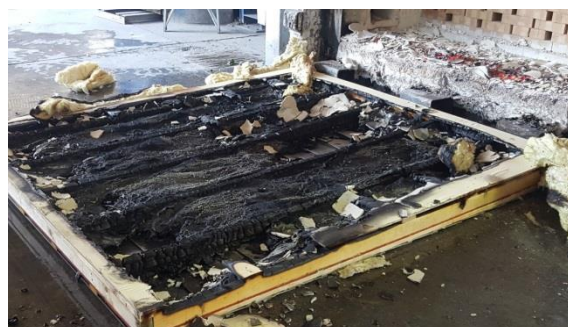
Figura N° 16 CARA EXPUESTA AL FUEGO POSTERIOR AL ENSAYO (41x65 mm)
