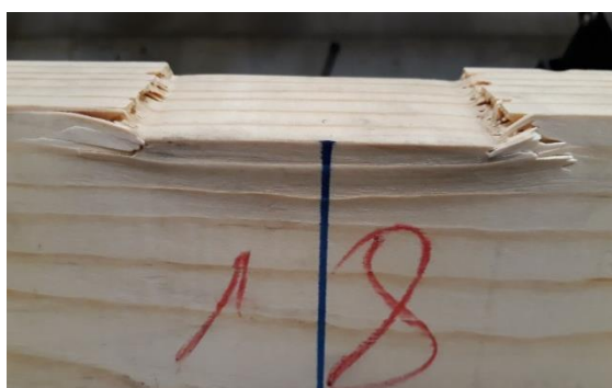
Figura N° 15 FALLA TÍPICA POR COMPRESIÓN NORMAL
