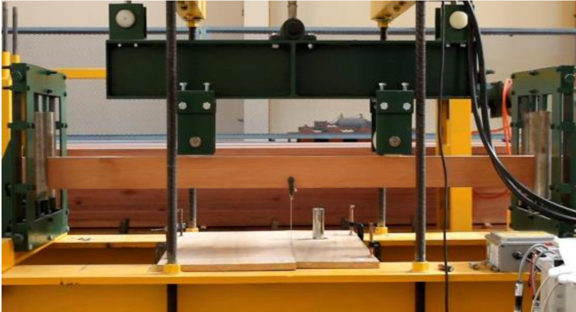
Figura N° 2 APLICACIÓN DEL ENSAYO DE RESISTENCIA Y RIGIDEZ EN FLEXIÓN EN LME-INFOR
