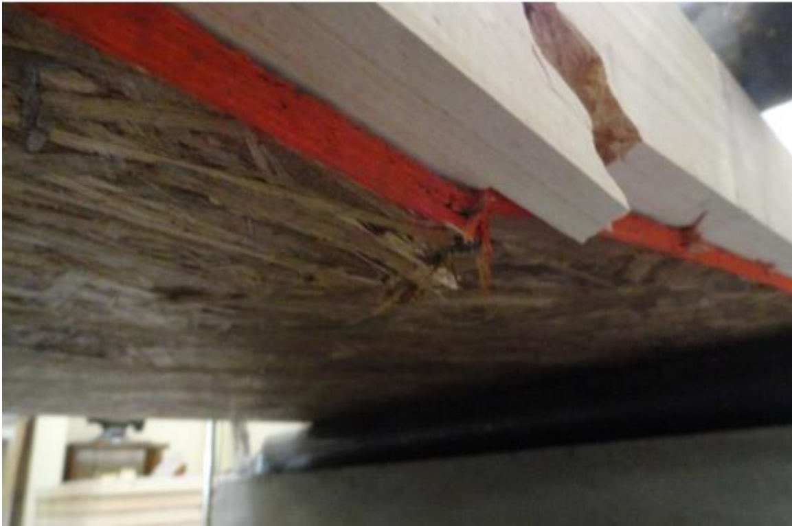
Figura N° 19 FALLA ENSAYO DE FLEXIÓN EN MUROS. CARGA APLICADA EN LA CARA INFERIOR. EN LME-INFOR
