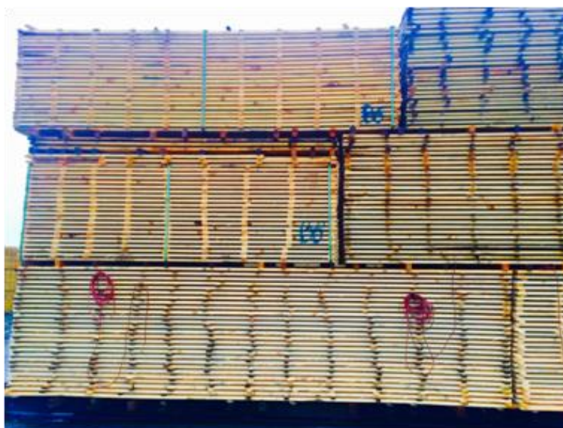
Figura N° 15 SENSORES DE HUMEDAD EN LINGAS
