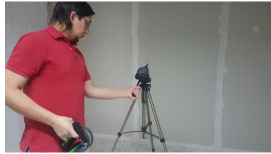
Figura N° 6 IMPLEMENTACIÓN DEL ENSAYO DE AISLACIÓN ACÚSTICA EN SALA RECEPTORA
