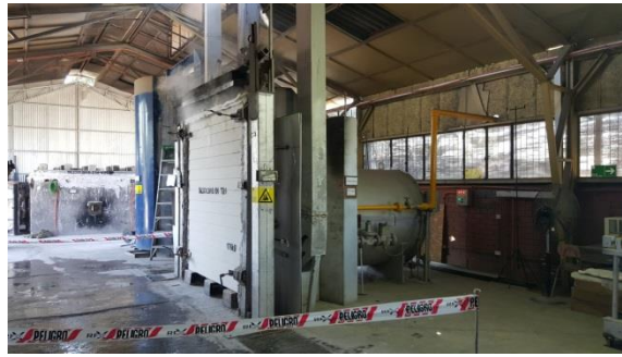
Figura N° 11 IMPLEMENTACIÓN DEL ENSAYO DE RESISTENCIA AL FUEGO
