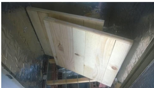
Figura N° 12 PROBETAS ENSAYO DE CONDUCTIVIDAD TÉRMICA
