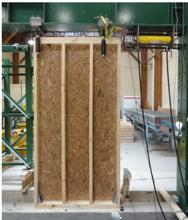
Figura N° 2 APLICACIÓN ENSAYO DE CARGA HORIZONTAL EN LME-INFOR
