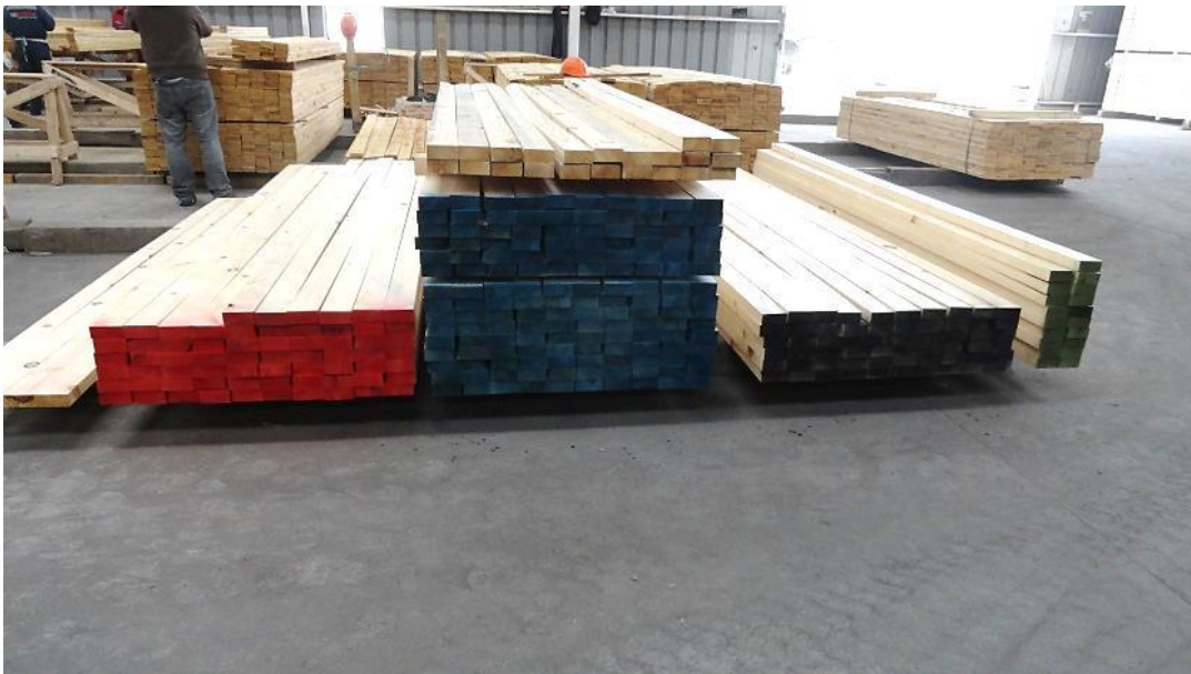
Figura N° 18 IDENTIFICACIÓN DE LOS GRADOS ESTRUCTURALES POR COLORES
