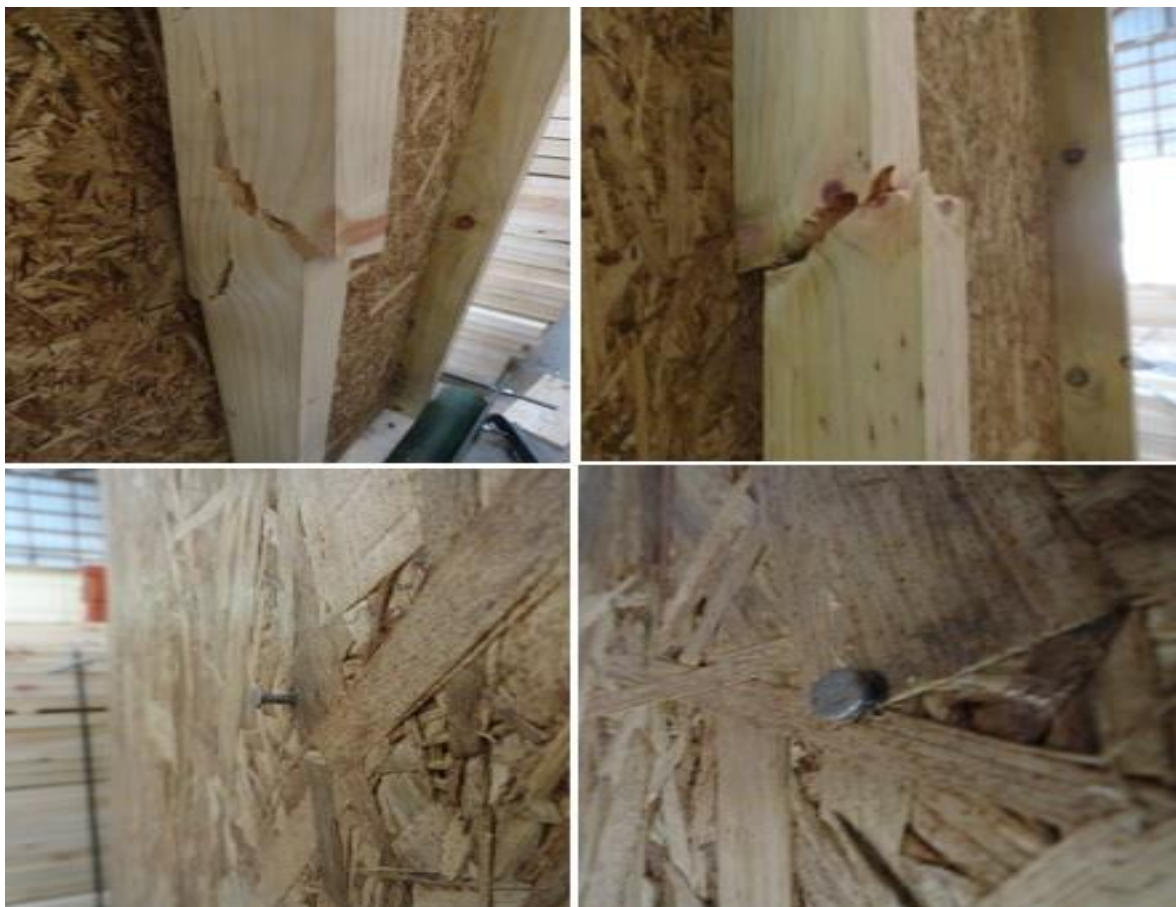
Figura N° 9 FALLAS TÍPICAS PRESENTADAS EN ENSAYO DE IMPACTO EN LME-INFOR
