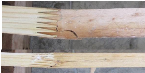
Figura N° 23 FALLAS EN EL ENSAYO DE FLEXIÓN FLAT
