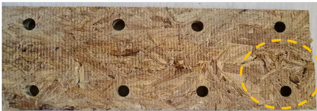
Figura N° 24 FALLA EN ENSAYO DE CORTE
