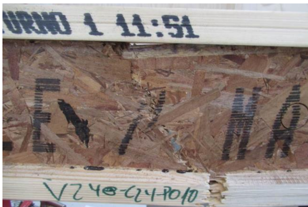
Figura N° 19 FALLA TÍPICA EN EL ENSAYO DE FLEXIÓN ALA EN TRACCIÓN (FT)
