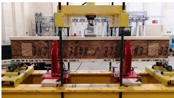
Figura N° 10 IMPLEMENTACIÓN DEL ENSAYO DE CORTE
