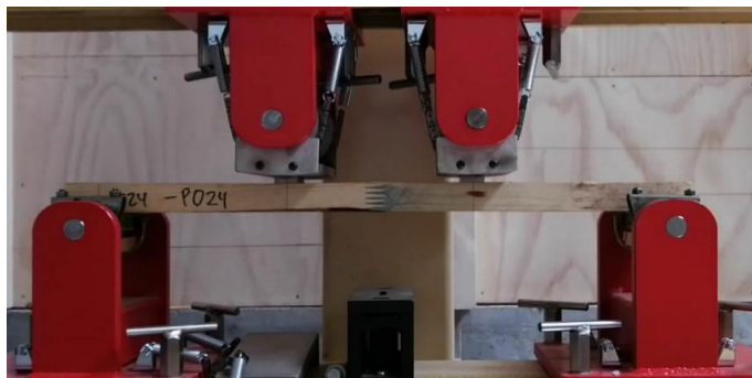
Figura N° 16 IMPLEMENTACIÓN ENSAYO DE FLEXIÓN FLAT, PIEZAS CON UNIÓN FINGER
