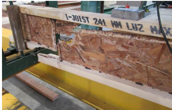
Figura N° 20 FALLA TÍPICA EN EL ENSAYO DE CORTE ZW EN OSB
