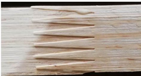
Figura N° 3 UNIÓN DENTADA Y ESQUEMA DE UNIÓN FINGER
