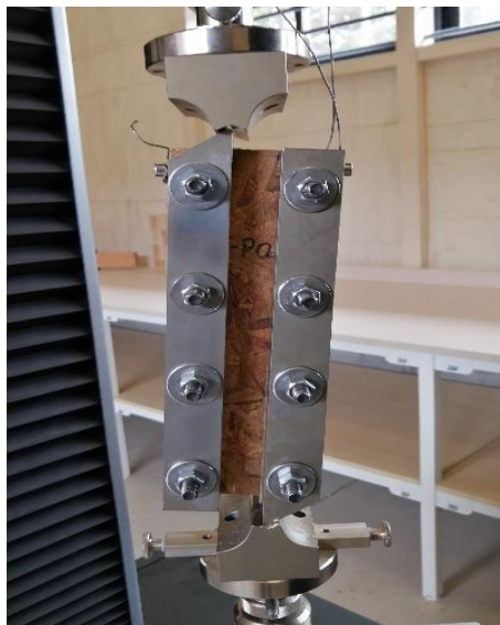
Figura N° 18 IMPLEMENTACIÓN DEL ENSAYO DE CORTE A TRAVÉS DEL ESPESOR DEL TABLERO
