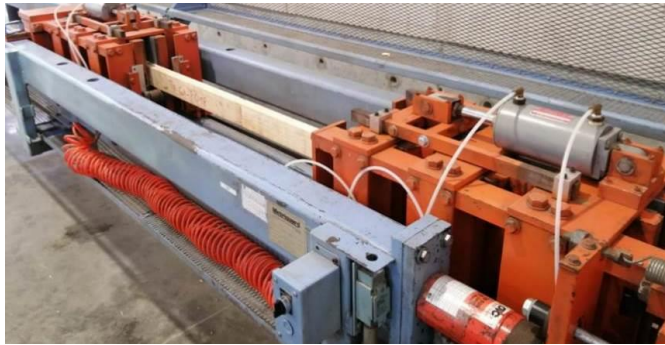
Figura N° 14 IMPLEMENTACIÓN ENSAYO TRACCIÓN UNIÓN FINGER
