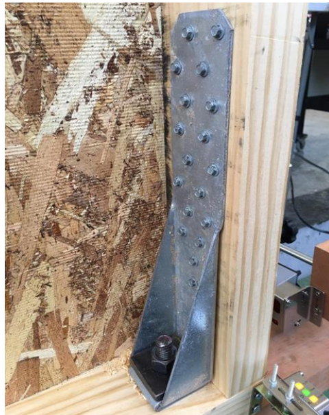
Figura N° 2 CONECTOR UTILIZADO EN EL ANCLAJE
