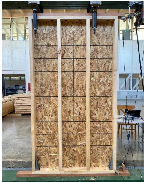
Figura N° 1 CONFIGURACIÓN DEL MURO
