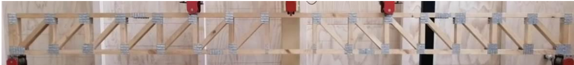
Viga con placa P1, reforzada
