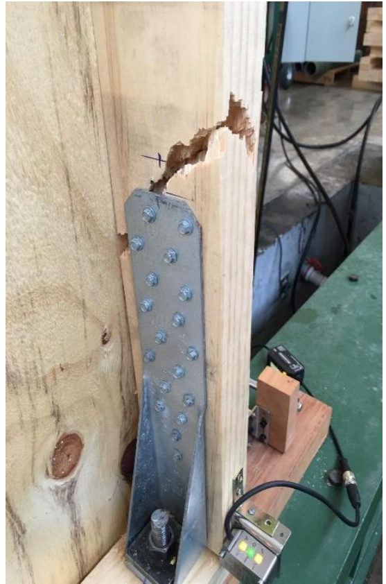
Figura N° 10 FALLA PIE DERECHO TRACCIONADO EN ZONA DE UNIÓN CON HERRAJE
