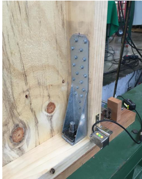
Figura N°2 CONECTOR UTILIZADO EN EL ANCLAJE
