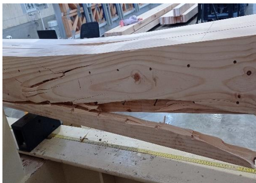
Figura N° 17 FALLA TÍPICA EN FLEXIÓN LAMINACIÓN VERTICAL CONTINUA
