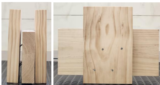
Figura N° 15 FALLA TÍPICA COMPRESIÓN PERPENDICULAR
