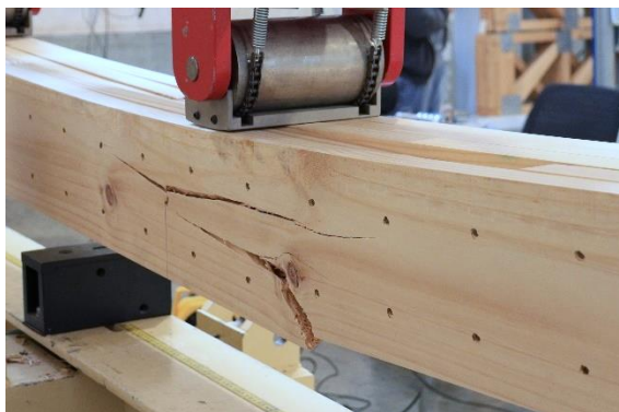
Figura N° 18 FALLA TÍPICA EN FLEXIÓN LAMINACIÓN VERTICAL CONTINUA
