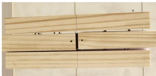
Figura N° 16 FALLA TÍPICA EN TRACCIÓN PARALELA
