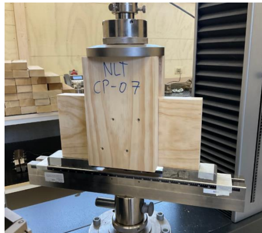
Figura N° 5 ESQUEMA DE ENSAYO COMPRESIÓN PERPENDICULAR E IMPLEMENTACIÓN
