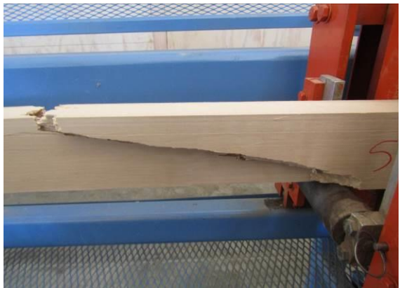
Figura N°13 TRACCIÓN PARALELA FALLA EN FIBRA DESVIADA
