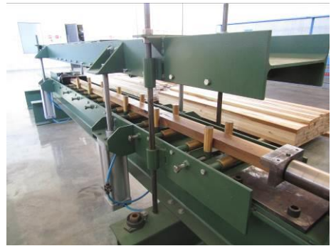
Figura N°6 IMPLEMENTACIÓN DEL ENSAYO A LA COMPRESIÓN PARALELA
