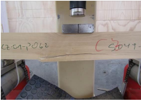
Figura N°14 CIZALLE FALLA EN SENTIDO LONGITUDINAL
