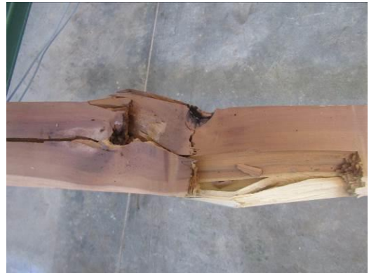
Figura N°15 COMPRESIÓN PARALELA FALLA EN FIBRA DESVIADA
