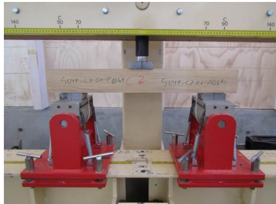
Figura N°8 IMPLEMENTACIÓN DEL ENSAYO AL CIZALLE
