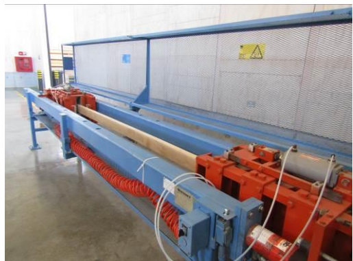
Figura N° 4 IMPLEMENTACIÓN ENSAYO DE TRACCIÓN
