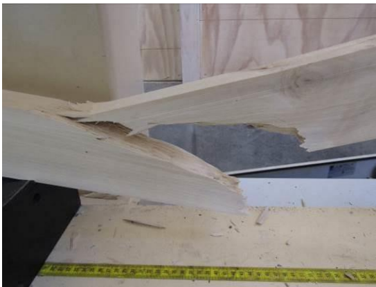
Figura N°12 FLEXIÓN FALLA DESDE BORDE EN TRACCIÓN
