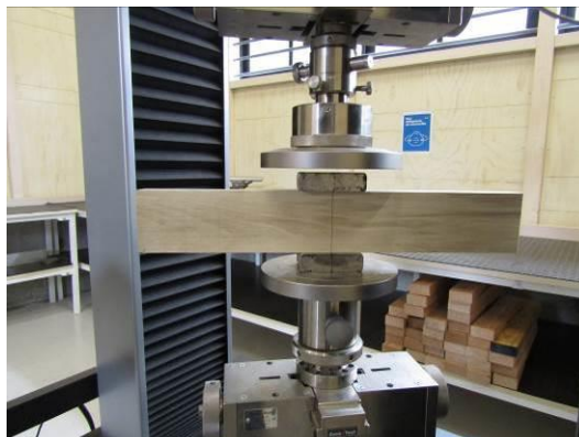
Figura N°10 IMPLEMENTACIÓN DEL ENSAYO A LA COMPRESIÓN NORMAL
