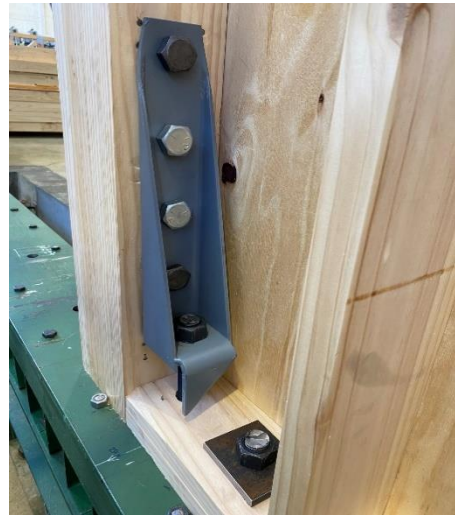
Figura N°7 CONECTOR UTILIZADO EN EL ANCLAJE TIPOLOGÍA MP-100/CP-MA (H)
