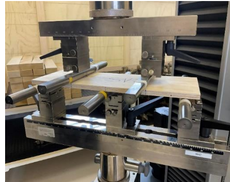
Figura N°2 IMPLEMENTACIÓN DEL ENSAYO DE CORTE RODANTE
