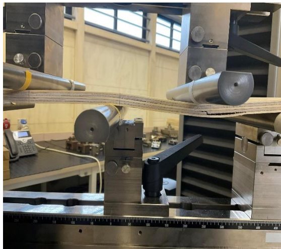
Figura N°8 FALLA POR CORTE RODANTE EN TABLEROS CONTRACHAPADOS
