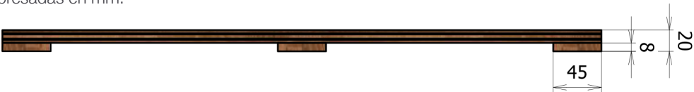
CORTE A-A' TABLERO MACHIHEMBRADO cotas expresadas en mm.
