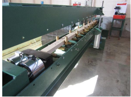
Figura N°6 IMPLEMENTACIÓN DEL ENSAYO A LA COMPRESIÓN PARALELA
