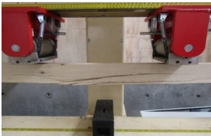
Figura N°11 FLEXIÓN FALLA DESDE BORDE EN TRACCIÓN
