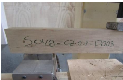
Figura N°13 CIZALLE FALLA EN SENTIDO LONGITUDINAL
