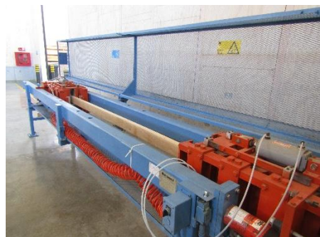
Figura N° 4 IMPLEMENTACIÓN ENSAYO DE TRACCIÓN
