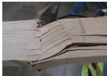
Figura N°14 COMPRESIÓN PARALELA FALLA EN FIBRA DESVIADA
