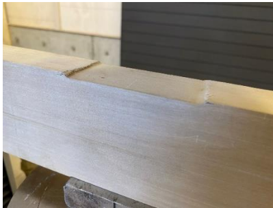
Figura N°15 COMPRESIÓN NORMAL FALLA POR APLASTAMIENTO LOCAL
