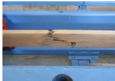
Figura N°12 TRACCIÓN PARALELA FALLA EN FIBRA DESVIADA
