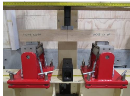
Figura N°8 IMPLEMENTACIÓN DEL ENSAYO AL CIZALLE
