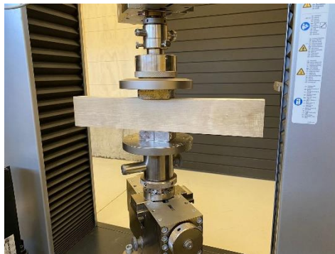
Figura N°10 IMPLEMENTACIÓN DEL ENSAYO A LA COMPRESIÓN NORMAL
