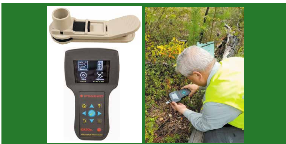
Figura 4.13. Fluorómetro y pinza para oscurecimiento de hojas (izq.); medición de plantas en terreno (der.).
