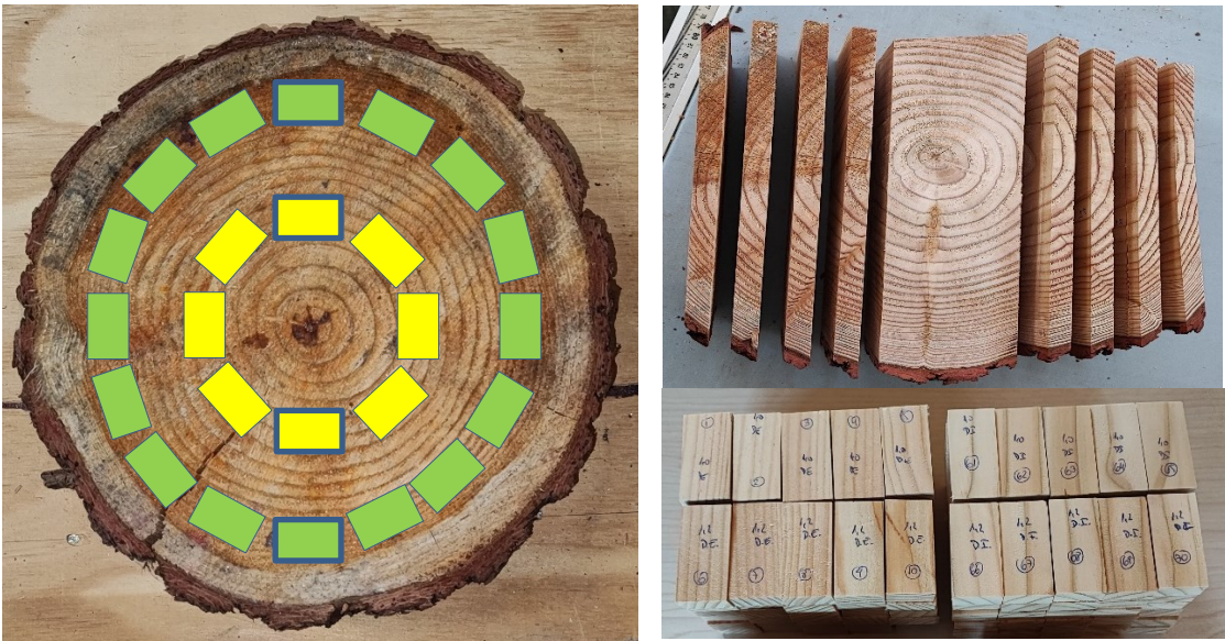
Figura N° 2 OBTENCIÓN DE PROBETAS DESDE DURAMEN INTERIOR Y EXTERIOR
