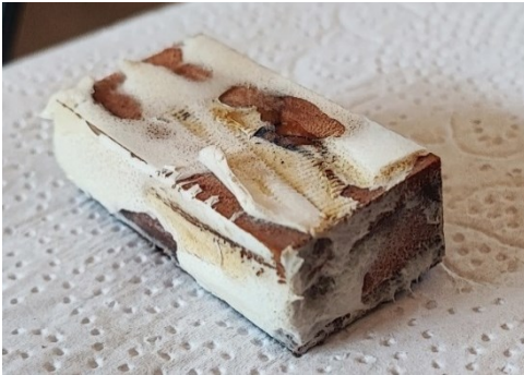
Figura N° 13 ATAQUE HONGO G.T. MADERA DE DURAMEN
