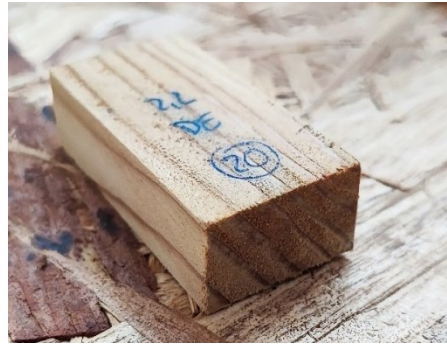
Figura N° 14 ATAQUE HONGO T.V. MADERA DE DURAMEN
