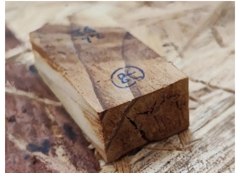
Figura N° 13 ATAQUE HONGO G.T. MADERA DE DURAMEN
