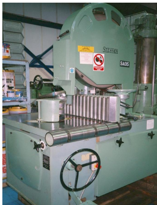
Figura N°3. Componentes de la máquina sierra huincha vertical partidora - compartidora
