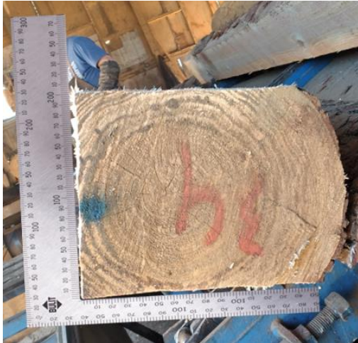
Figura N°22. Descuadre de semi-basa
