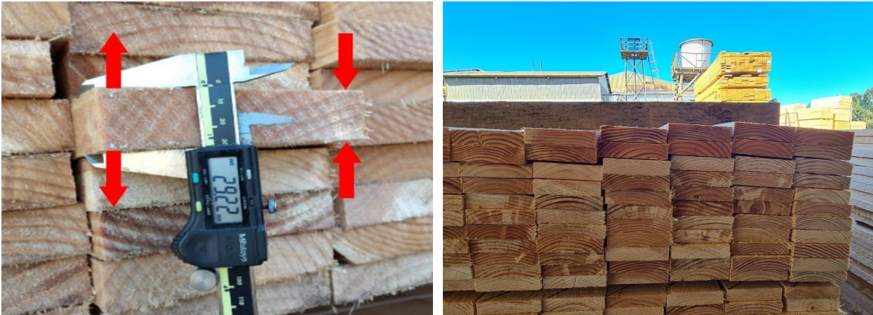
Figura 18. Acufiamiento en el espesor y ancho de la pieza
