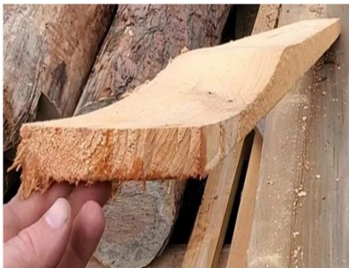
Figura N°11. Variación dimensional en el espesor de la pieza
