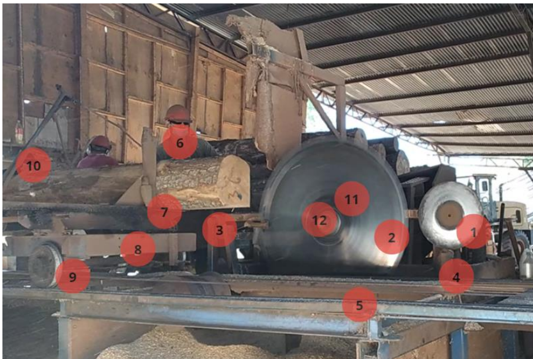
Figura N°7. Componentes de la máquina sierra circular con carro lateral
