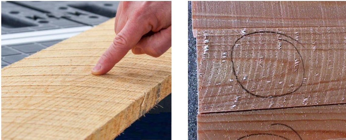
Figura N° 21. Raya radial en la superficie de la pieza
