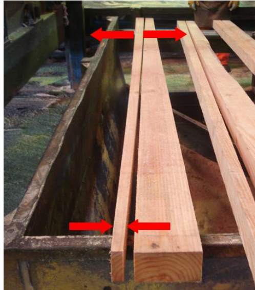
Figura N°19. Acuñamiento en el espesor y ancho de la pieza
