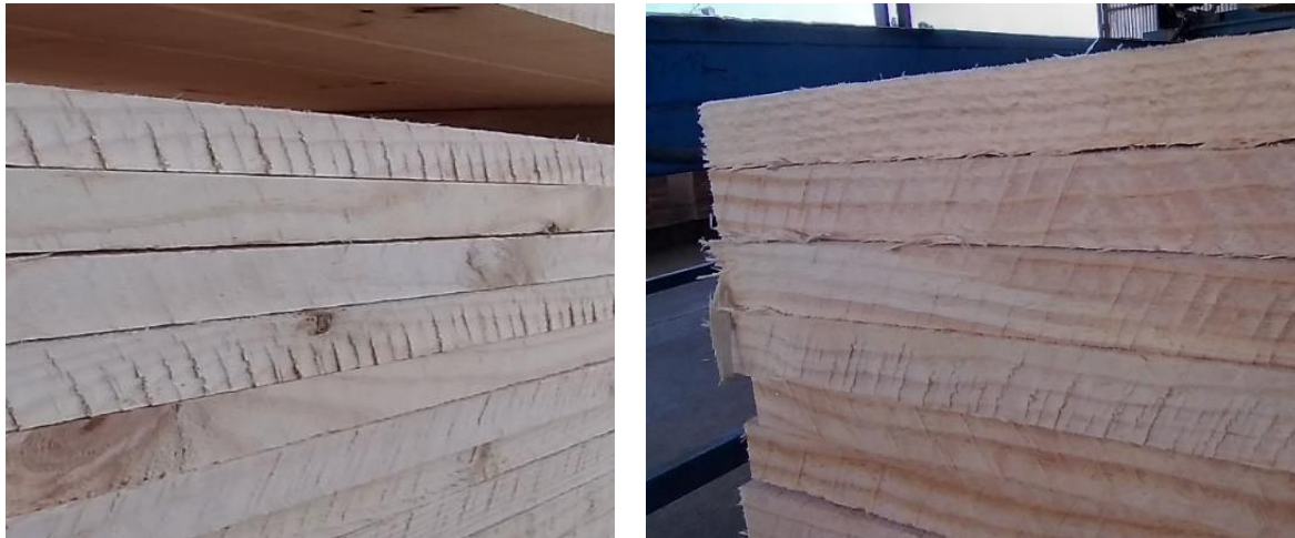
Figura N°13. Surcos de sierra en el canto de la pieza
