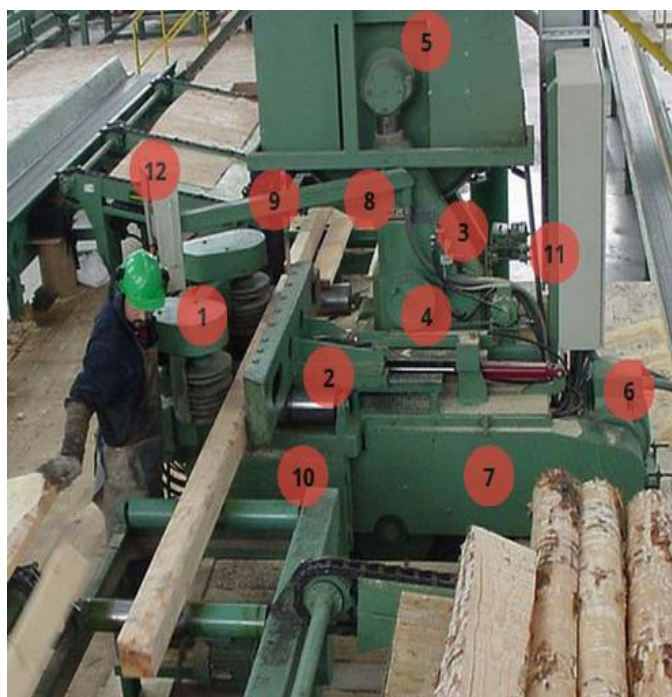
Figura N°3. Componentes de la máquina sierra huincha vertical partidora - compartidora
