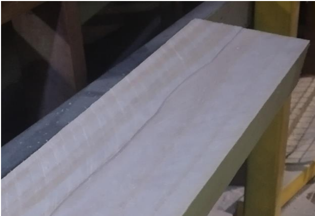
Figura 14. Desfase en la cara de la pieza
