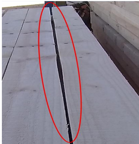
Figura N°12. Variación dimensional en el ancho de la pieza
