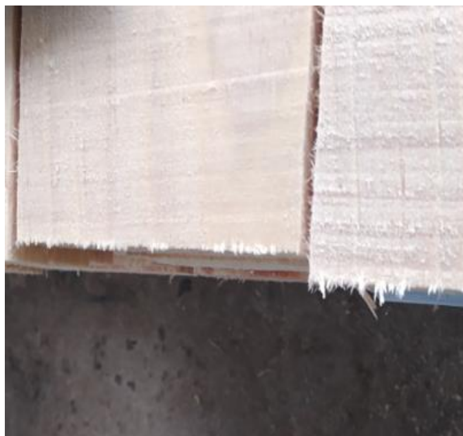
Figura N°26. Corte con hilachas
