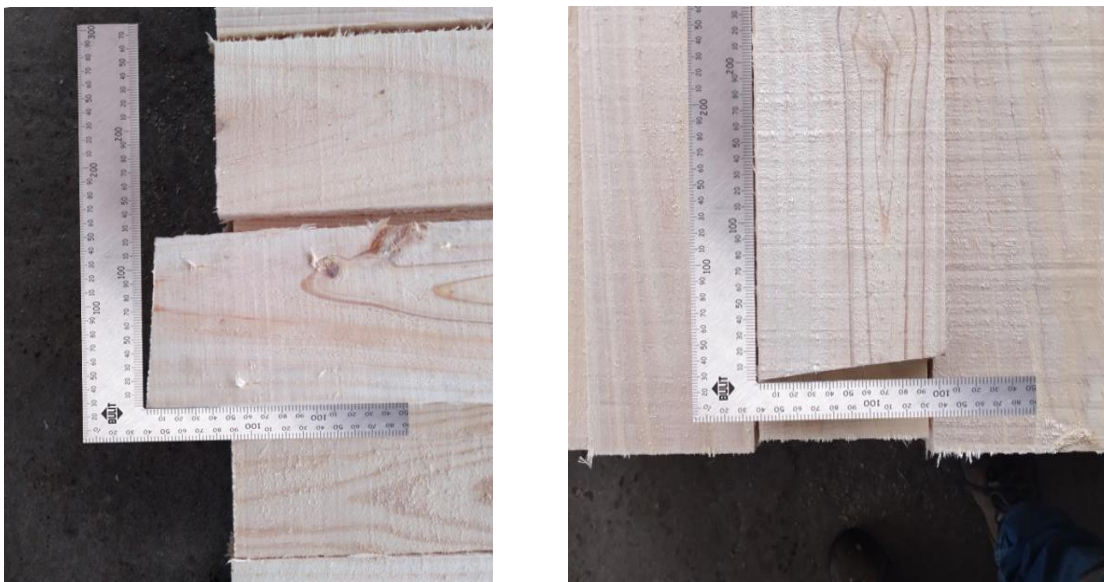
Figura N° 25. Despunte descuadrado en la pieza
