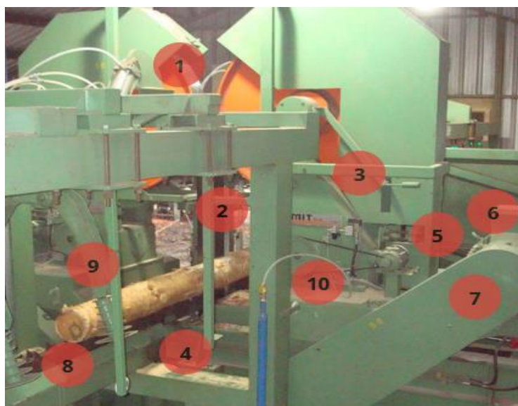
Figura N°2. Componentes de la máquina sierra huincha vertical doble
