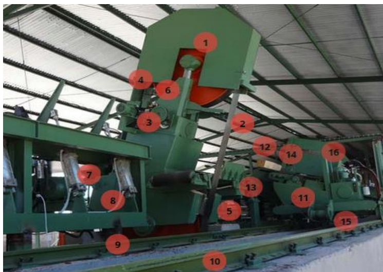
Figura N°4. Componentes de la máquina sierra huincha con inclinación lateral mono o bi-corte, con carro lateral
