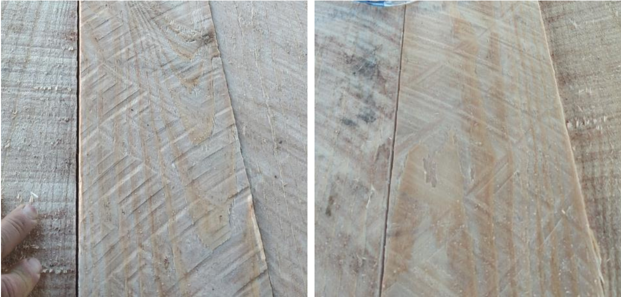
Figura N°16. Contra corte en la cara de la pieza
