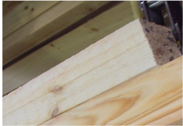
Figura 15. Desfase en la cara de la pieza
