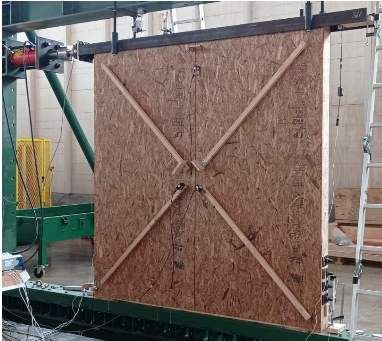
Figura N°2 CONFIGURACIÓN DEL ENSAYOS DE MURO
