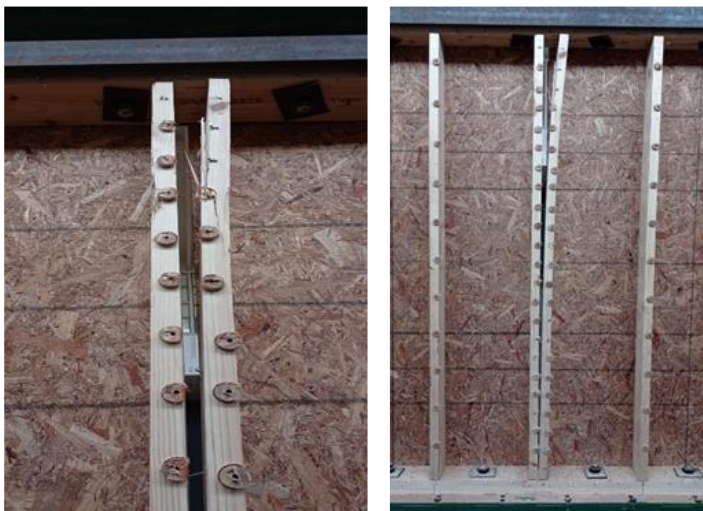
Figura N°15 DESCLAVADO DE PIE DERECHOS INTERMEDIOS
