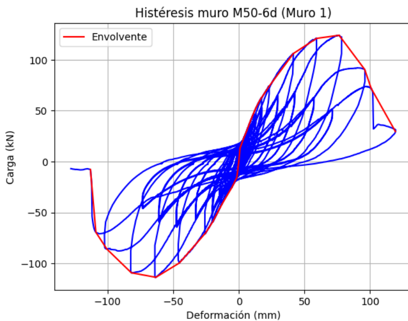
Figura N°8 CURVA DE HISTÉRESIS - TIPOLOGÍA: M50-6d (Muro 1)
