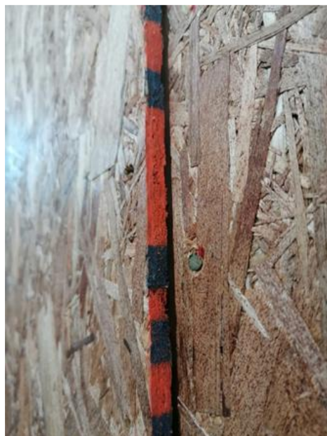
Figura N°14 DESPLAZAMIENTO RELATIVO ENTRE TABLEROS OSB
