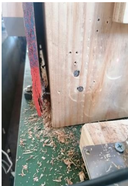
Figura N°13 FLUENCIA DEL CLAVO Y APLASTAMIENTO DEL TABLERO OSB
