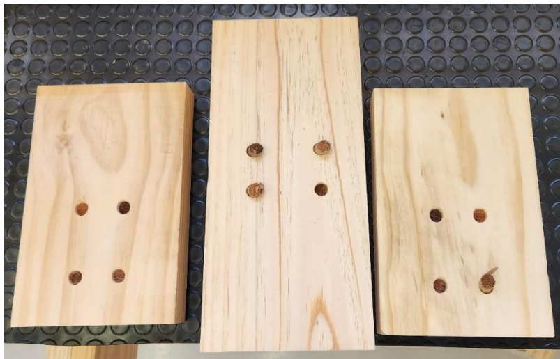
Figura N° 12 Falla típica en compresión perpendicular
