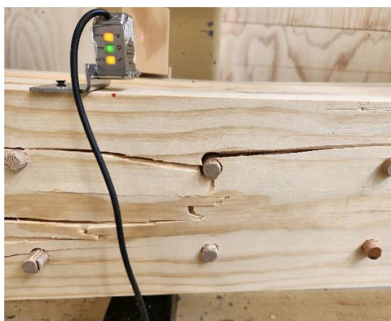
Figura N° 18 Falla típica en flexión laminación con empalme
