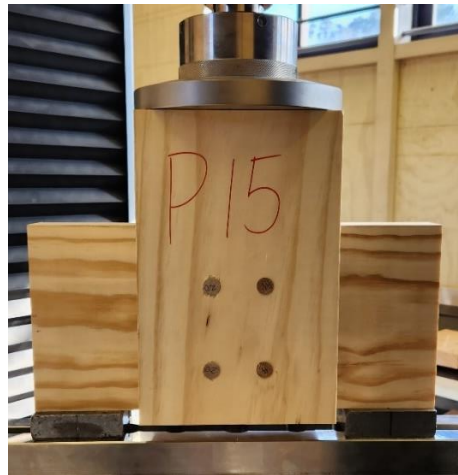
B) Implementación del ensayo a la compresión perpendicular
