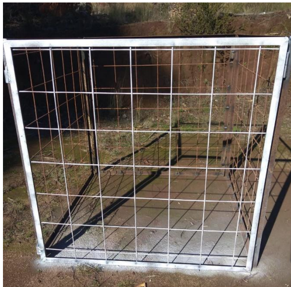
Figura N° 9. Metro cúbico fabricado para estimación de volumen en diferentes formatos de venta
