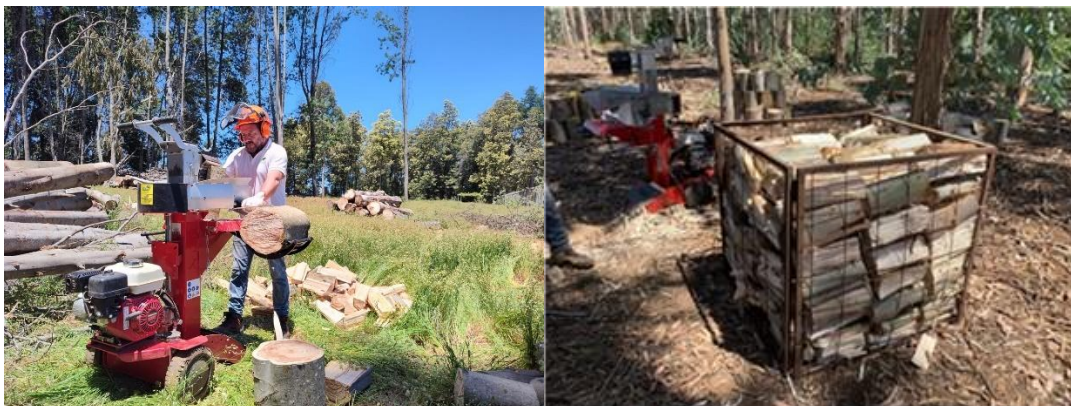
Figura N° 10. Producción de astillas para obtención de su número según la dimensión del árbol y especie, y disposición en unidad de comercialización para conteo final del número de astillas en este formato de venta y evaluar a cuanto equivale un árbol en metros cúbicos
