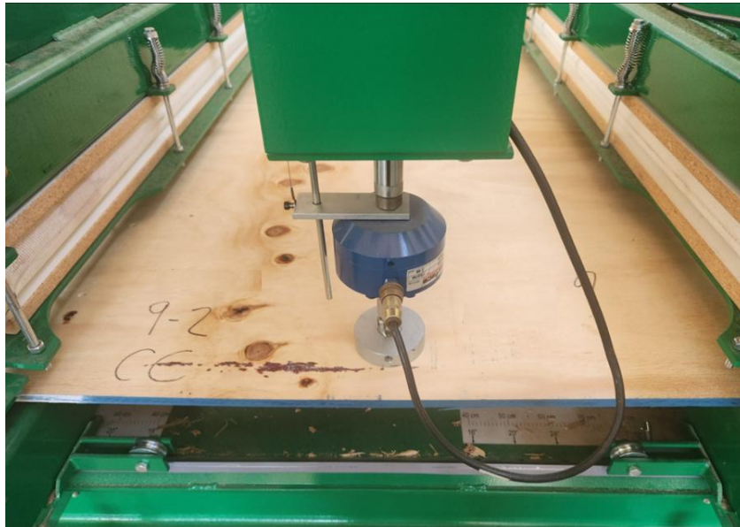
Figura N° 13 Ensayo de Carga estática concentrada. LME – INFOR.
