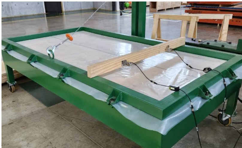
Figura N°6. Implementación del ensayo a carga uniforme
