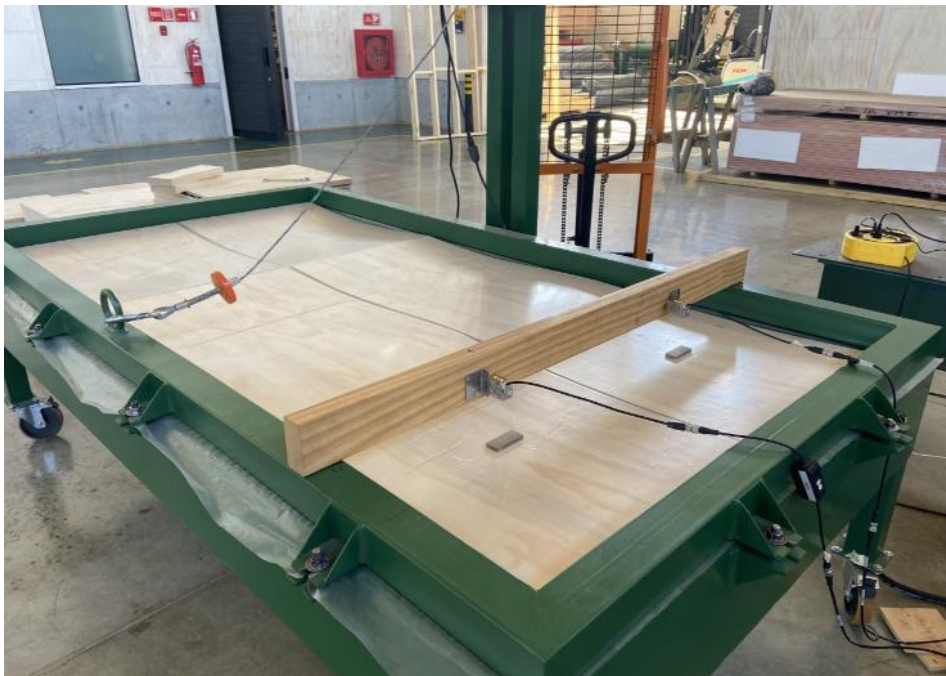
Figura N° 18 Ensayo de Desempeño bajo cargas uniformes a span 32. LME – INFOR
