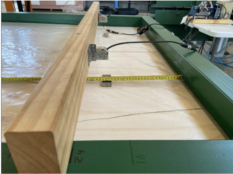
Figura N° 17 Ensayo de Desempeño bajo cargas uniformes a span 24. LME – INFOR
