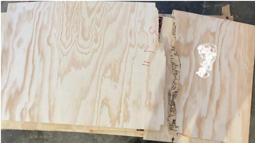
Figura N° 11 Probeta longitudinal ensayada, falla paralela a la orientación del eje resistente. LME – INFOR.
