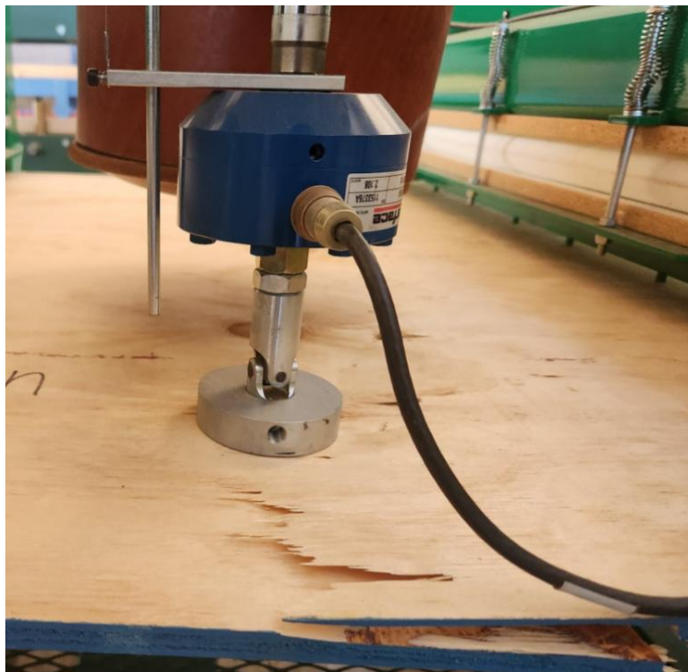
Figura N° 14 Probeta ensayada en Carga estática concentrada con impacto, registro de espesor en zona de rotura. LME – INFOR.
