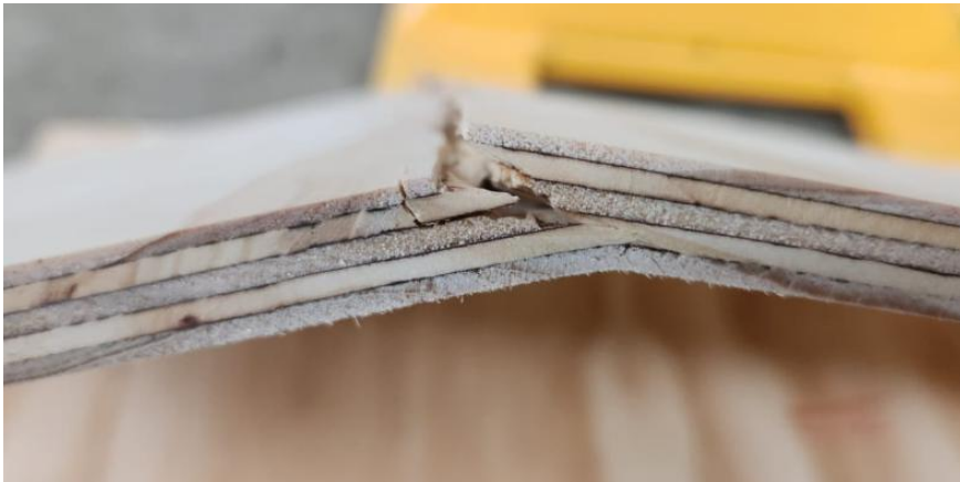
Figura N° 9 Probeta ensayada, registro de espesor en zona de rotura. LME – INFOR.
