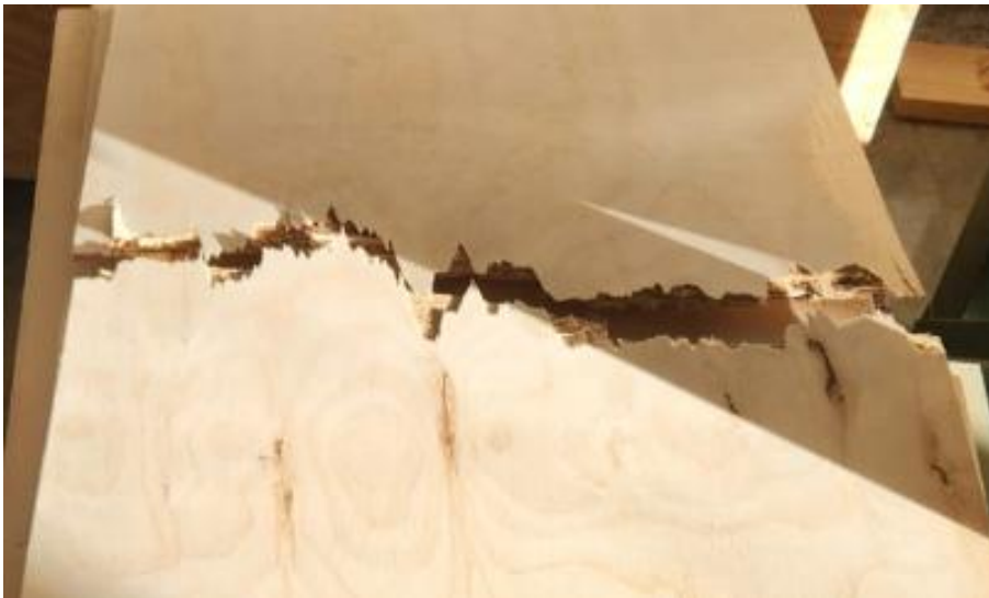
Figura N° 8 Probeta longitudinal ensayada, falla perpendicular a la orientación del eje resistente. LME – INFOR.
