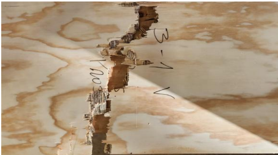
Figura N° 10 Probeta longitudinal ensayada, falla perpendicular a la orientación del eje resistente. LME – INFOR.
