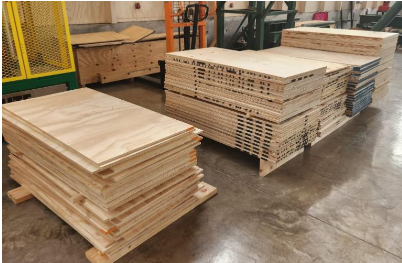
Figura N° 7 Probetas de 610x1220 mm, 200 unidades, para ensayo de flexión de tablero grande. LME INFOR.
