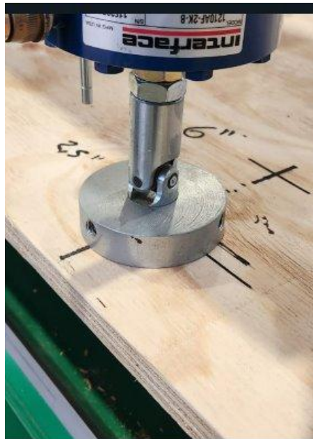
Figura N° 12 Carga de calibración de máquina de ensayos para Carga estática concentrada y Carga estática concentrada con impacto. LME – INFOR.
