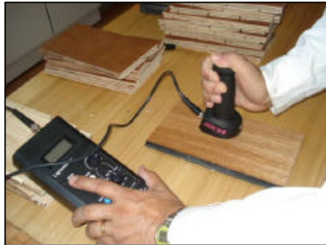
Medición del contenido de humedad con xilohigrómetro
