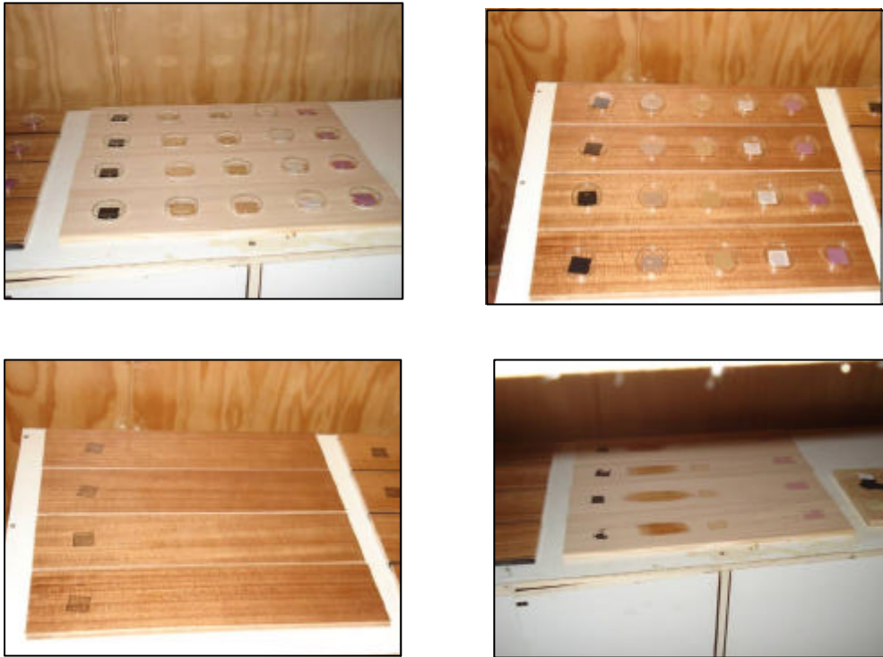
Figura N° 5. Evaluación de la resistencia a los agentes químicos
