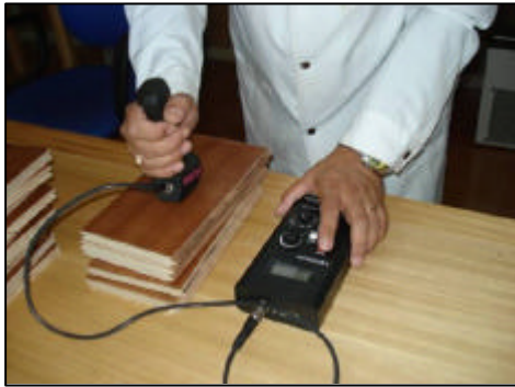
Medición del contenido de humedad con xilohigrómetro
