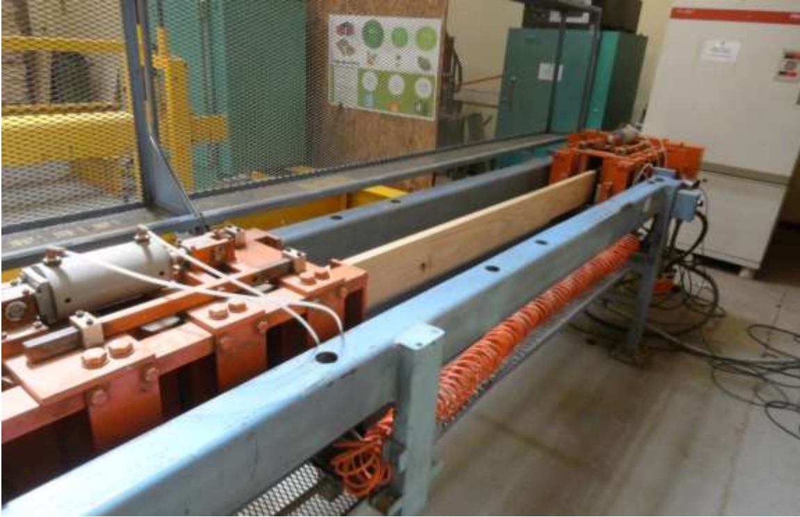
Figura 2.4: Aplicación de un ensayo de resistencia a la tracción paralela a las fibras. Fuente: LME-INFOR.
