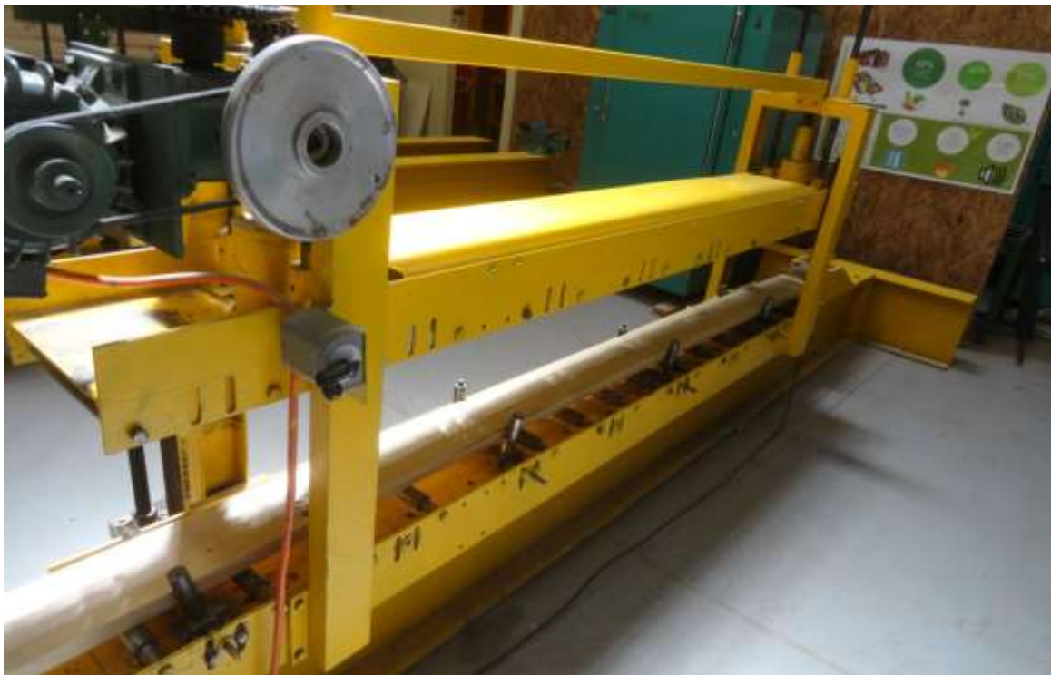
Figura 2.6: Aplicación de un ensayo de resistencia a la compresión paralela a las fibras. Fuente: LME-INFOR.
