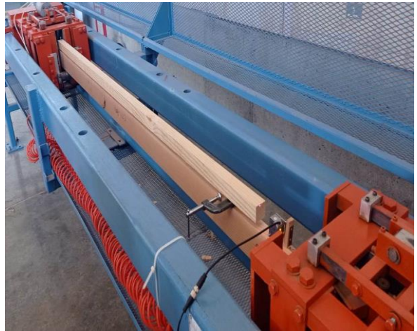
Figura N°6 IMPLEMENTACIÓN DEL ENSAYO MOE LONGITUDINAL EN TRACCIÓN
