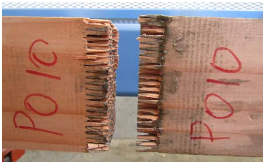
Figura N° 15 FALLA TÍPICA EN PAREDES DEL DIENTE
