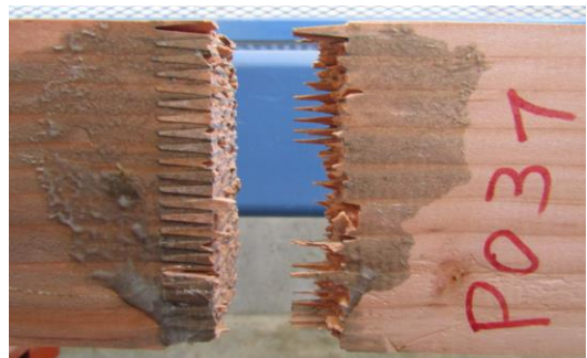
Figura N° 16 FALLA TÍPICA EN LA BASE DEL DIENTE
