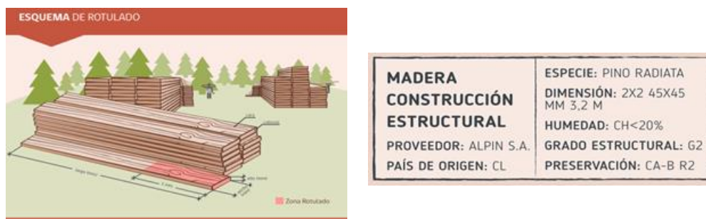
Figura N° 14. ESQUEMA DE ROTULADO Y RÓTULO REFERENCIAL DE MADERA PARA USO ESTRUCTURAL
