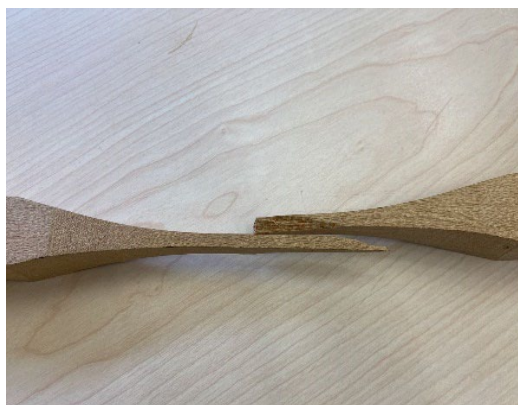
Figura N°9 FALLA POR TRACCIÓN PARALELA
