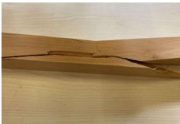
Figura N°8 FALLA POR FLEXIÓN
