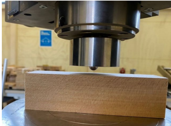
Figura N°6 IMPLEMENTACIÓN DEL ENSAYO DE DUREZA
