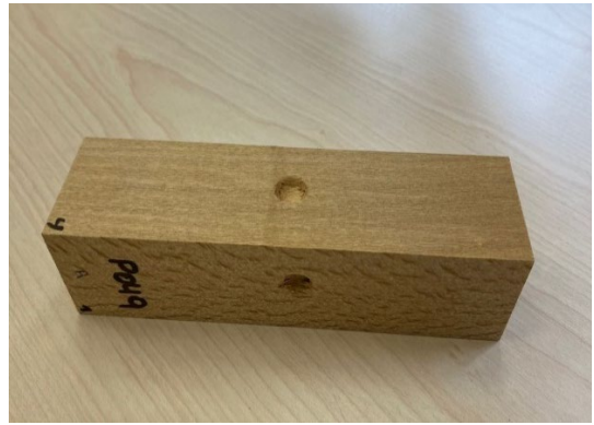
Figura N°13 FALLA POR DUREZA
