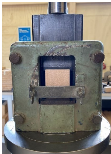
Figura N°3 IMPLEMENTACIÓN DEL ENSAYO AL CIZALLE
