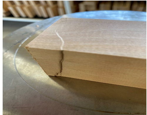
Figura N°11 FALLA POR COMPRESIÓN PARALELA
