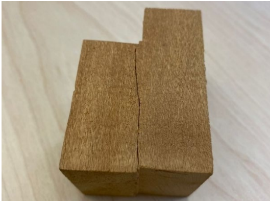
Figura N°10 FALLA POR CIZALLE
