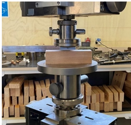
Figura N°5 IMPLEMENTACIÓN DEL ENSAYO A LA COMPRESIÓN NORMAL
