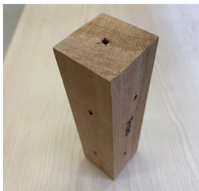
Figura N°14 FALLA POR EXTRACCIÓN DE CLAVO
