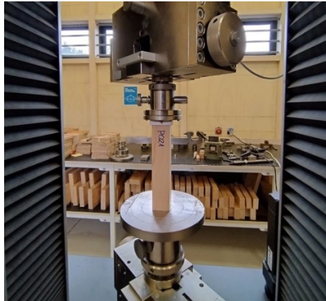
Figura N°4 IMPLEMENTACIÓN DEL ENSAYO A LA COMPRESIÓN PARALELA
