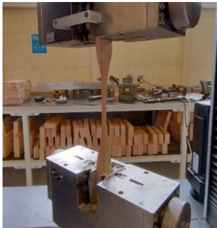
Figura N°2 IMPLEMENTACIÓN ENSAYO DE TRACCIÓN
