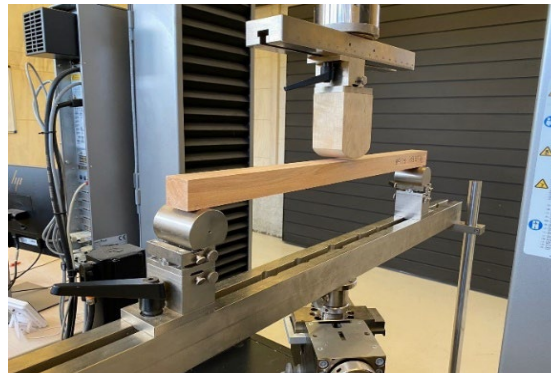
Figura N°1 IMPLEMENTACIÓN ENSAYO DE FLEXIÓN
