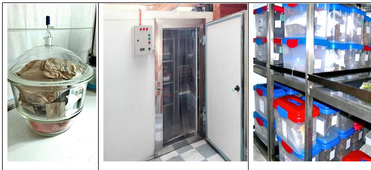
Figura 10. Desecador de sílica gel (izquierda); vista exterior e interior de cámara de frío para almacenamiento de semillas de INFOR Biobío (centro y derecha).
