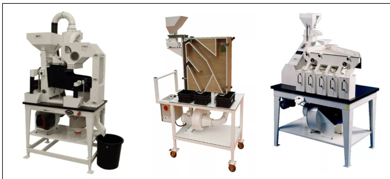
Figura 15. Tamices para limpieza de semillas (izquierda y centro). Equipo agitador de tamices mediante vibración, con control de tiempo y amplitud de la vibración (derecha).
