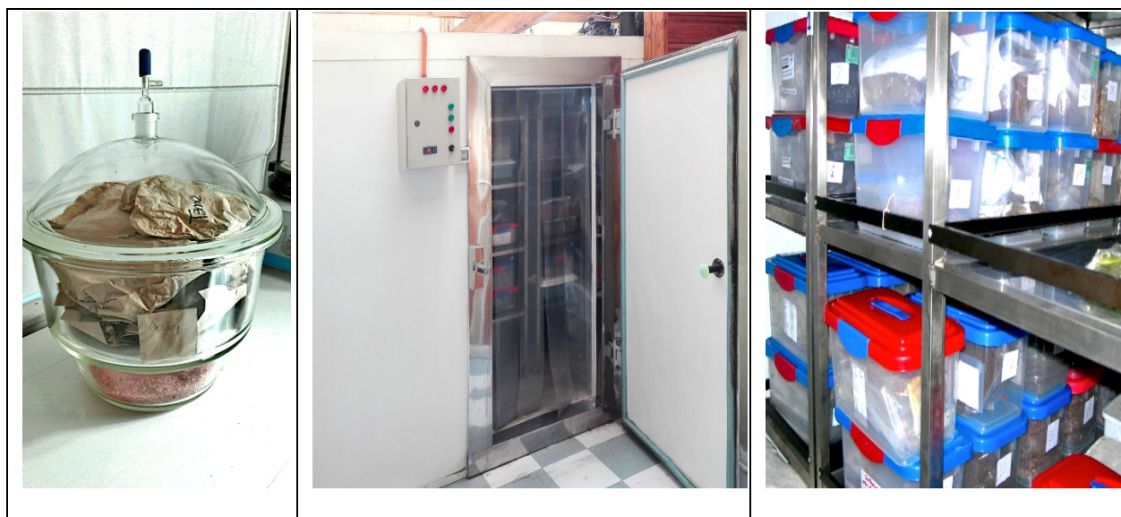
Figura 10. Desecador de sílica gel (izquierda); vista exterior e interior de cámara de frío para almacenamiento de semillas de INFOR Biobío (centro y derecha).
