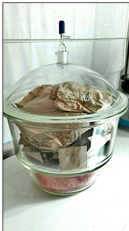
Figura 20. Secado de semillas en recipientes con gel de sílice
