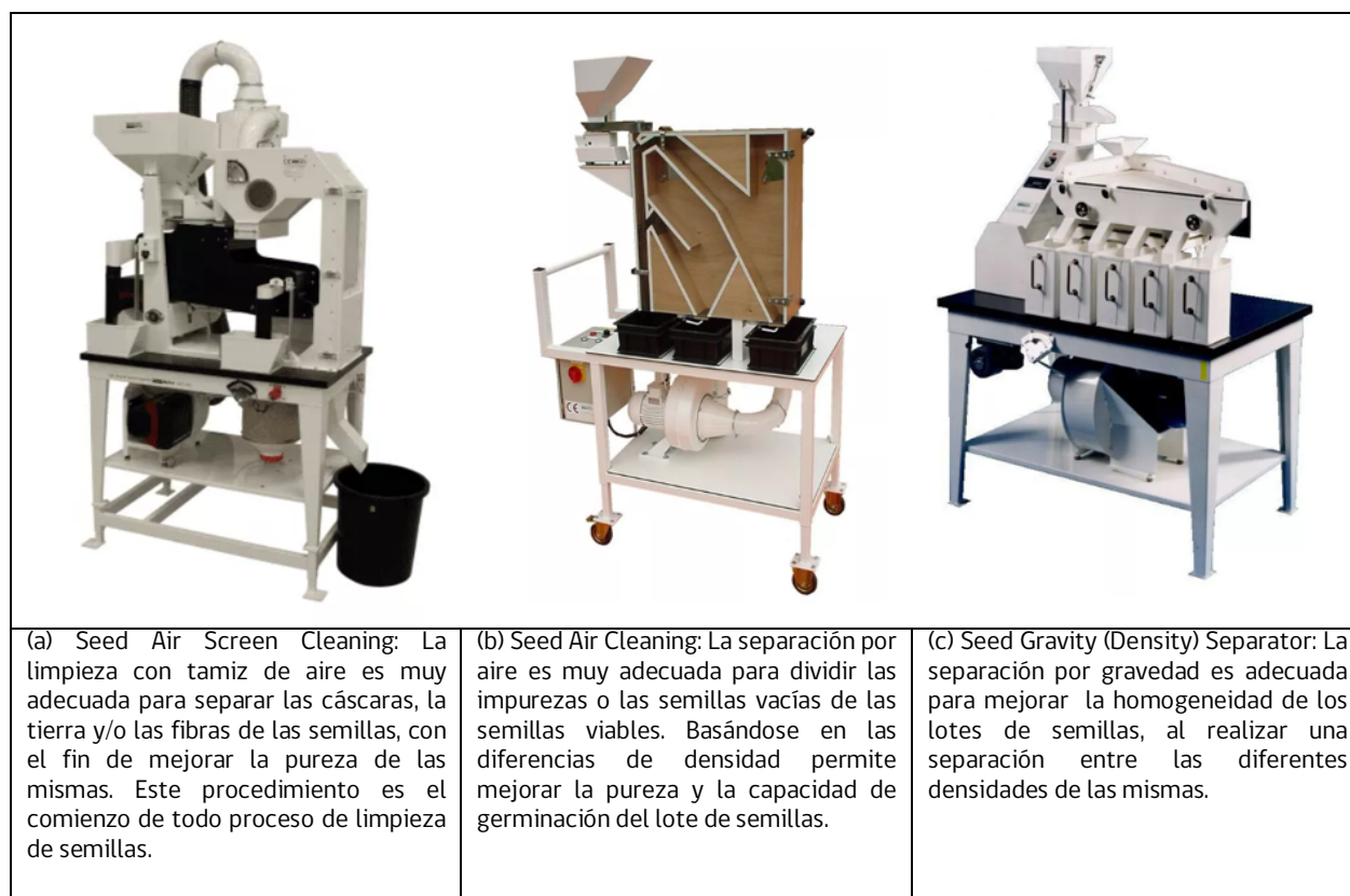
Figura 16. Equipos para limpieza y calibración de semillas. Dentro de cada tipo hay modelos de diferente capacidad y rendimiento
