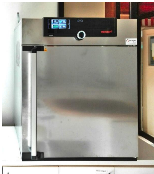
Figura 17. Equipo para determinación de contenido de humedad en laboratorios de INFOR Biobío. Termobalanza para determinación directa del contenido de humedad (Izq). Horno de secado para determinación de contenido de humedad por método tradicional de diferencia de peso (der).
