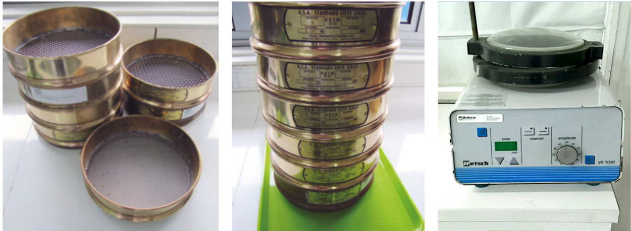
Figura 15. Tamices para limpieza de semillas (izquierda y centro). Equipo agitador de tamices mediante vibración, con control de tiempo y amplitud de la vibración (derecha).
