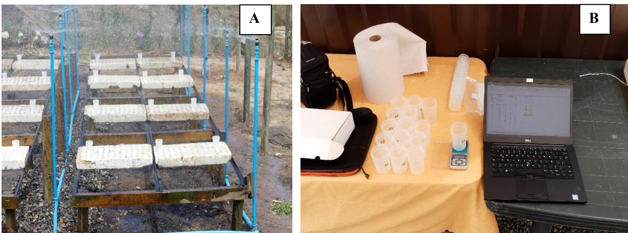
Figura 11. (A) Toma de muestras desde el sistema de riego en funcionamiento para la determinación del coeficiente de uniformidad de riego (CU). (B) Pesaje de muestras y cálculo del CU en planilla Excel. Para más detalle respecto a su determinación, véase el siguiente tutorial https://www.youtube.com/watch?v=U7noowHCyBE&t=144s .
