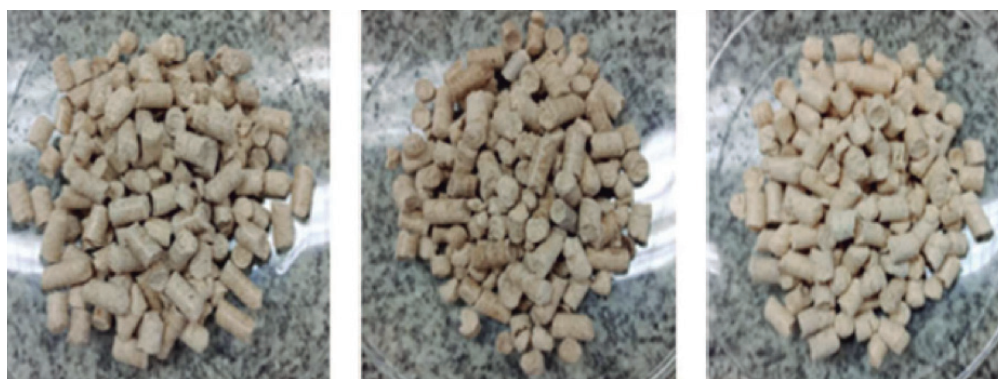
Figura 9. Pellet producido a partir de la mezcla de biomasa de Eucalyptus nitens y Pinus radiata . De izquierda a derecha 50/50, 25/75 y 75/25 nitens/radiata.
