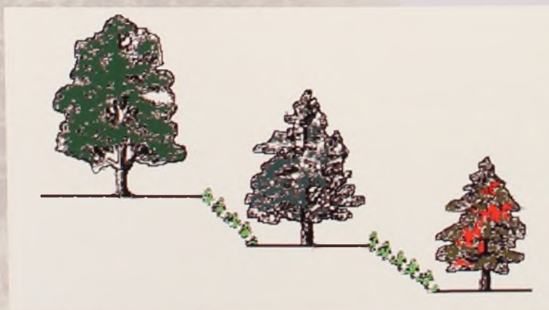
Figura 16. Cortina forestal para la estabilización de taludes
