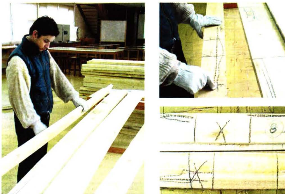
FIGURA 5 MARCACIÓN E IDENTIFICACIÓN DE DEFECTOS
