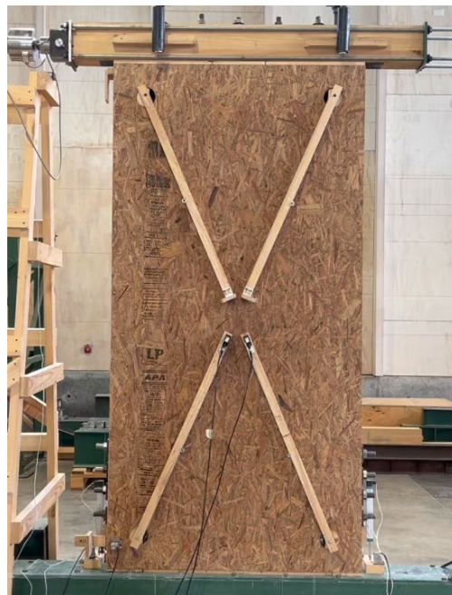
Figura N°7 CONFIGURACIÓN DE ENSAYOS DE MURO SIN REVESTIMIENTO DE YESO CARTÓN
