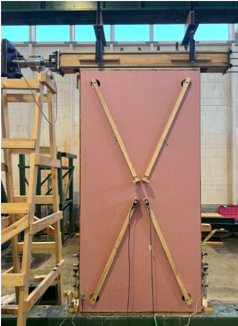
Figura N°5 CONFIGURACIÓN DE ENSAYOS DE MURO CON REVESTIMIENTO
