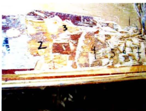
Figuras 2 y 3: Desgarro de madera por cada línea de cola, tableros pino y eucalyptus
