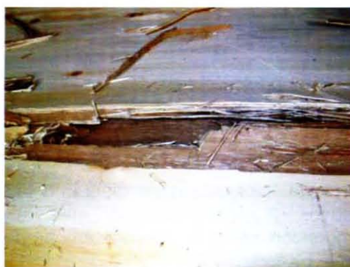
Figuras 2 y 3: Desgarro de madera por cada línea de cola, tableros pino y eucalyptus
