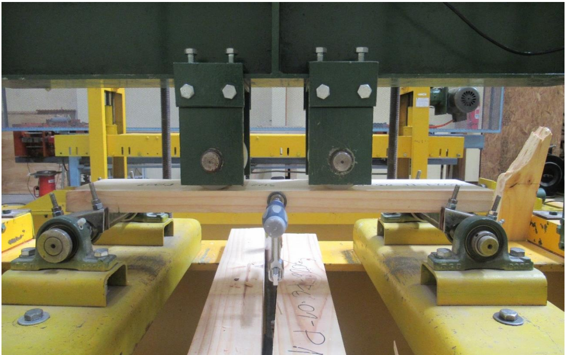
Figura N° 3 APLICACIÓN ENSAYO DE RESISTENCIA Y RIGIDEZ EN FLEXIÓN POSICIÓN DE CARA NCH 3028/1
