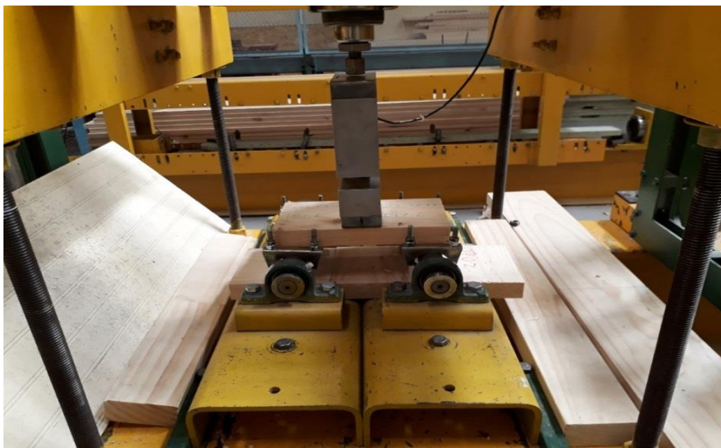
Figura N° 10 APLICACIÓN ENSAYO RESISTENCIA AL CIZALLE PARALELO POSICIÓN DE CARA NCh 3028/1
