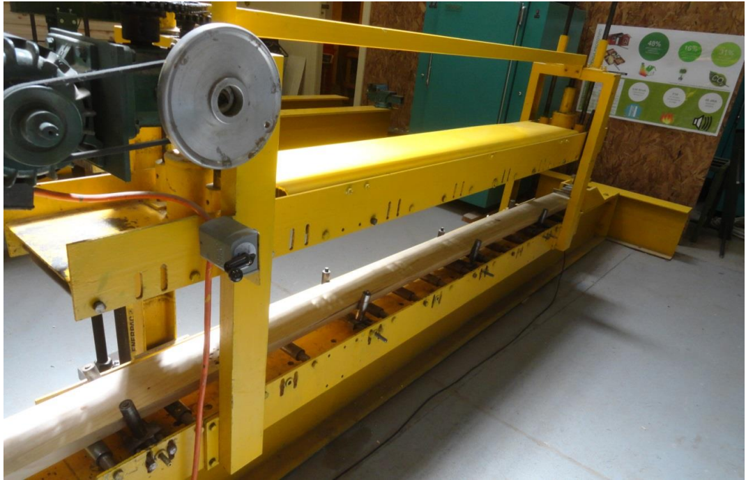
Figura N° 7 APLICACIÓN ENSAYO DE RESISTENCIA A LA COMPRESIÓN PARALELA NCh 3028/1
