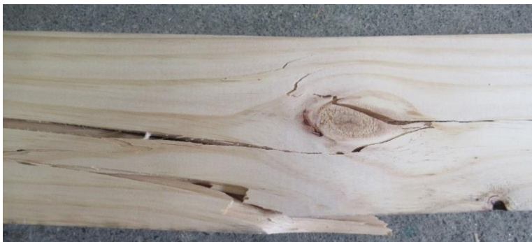
Figura N° 11 FALLA ENSAYO FLEXIÓN POSICIÓN DE CANTO PARA LAMINACIÓN VERTICAL
