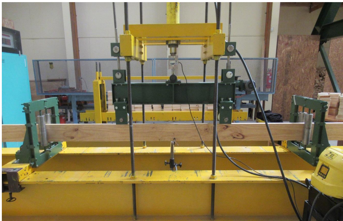
Figura N° 2 APLICACIÓN ENSAYO DE RESISTENCIA Y RIGIDEZ EN FLEXIÓN EN POSICIÓN DE CANTO NCh 3028/1
