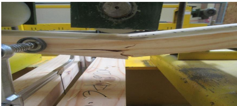
Figura N° 12 FALLA ENSAYO FLEXIÓN POSICIÓN DE CARA PARA LAMINACIÓN HORIZONTAL
