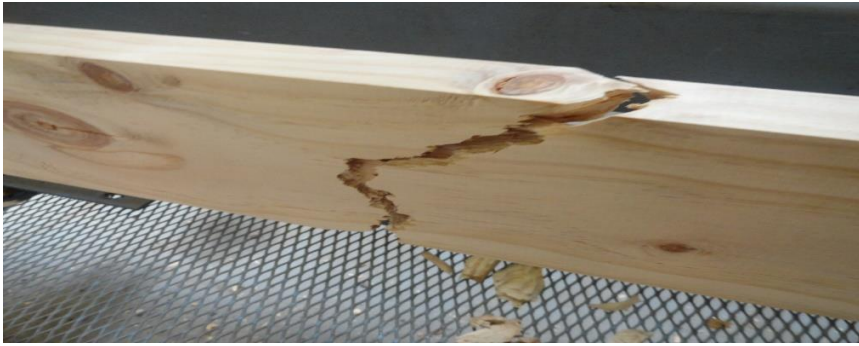
Figura N° 13 FALLA ENSAYO TRACCIÓN PARALELA A LA FIBRA
