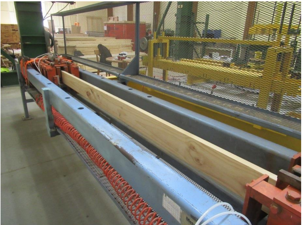
Figura N° 5 APLICACIÓN ENSAYO DE RESISTENCIA A LA TRACCIÓN PARALELA NCh 3028/1
