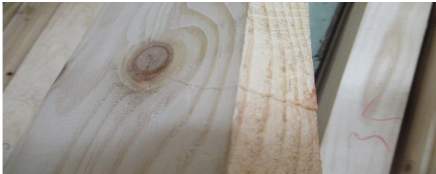
Figura N° 14 FALLA ENSAYO COMPRESIÓN PARALELA A LAS FIBRAS
