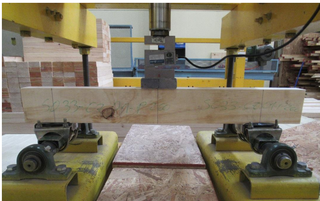
Figura N° 9 APLICACIÓN ENSAYO RESISTENCIA AL CIZALLE PARALELO POSICIÓN DE CANTO NCh 3028/1
