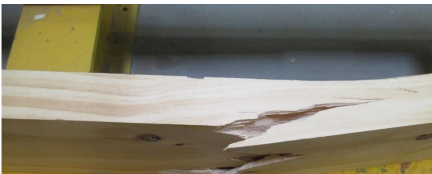
Figura N° 16 FALLA ENSAYO CIZALLE PARALELO POSICIÓN DE CARA PARA LAMINACIÓN HORIZONTAL
