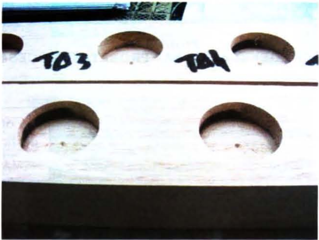
FIGURA 89 ENSAYO DE TALADRADO CON HERRAMIENTA DE 34,5 mm DE DIÁMETRO. QUEMADURAS EN EL FONDO
