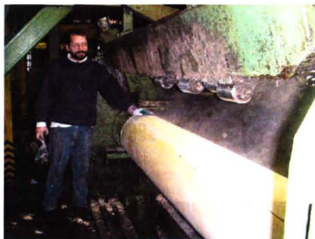
FIGURA 102 TROZAS ANTES Y DURANTE EL DEBOBINADO
