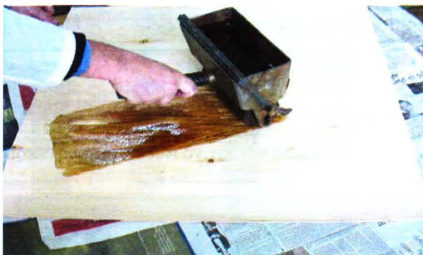
FIGURA 113 LÁMINAS DE Eucalyptus nitens DURANTE EL ENCOLADO
