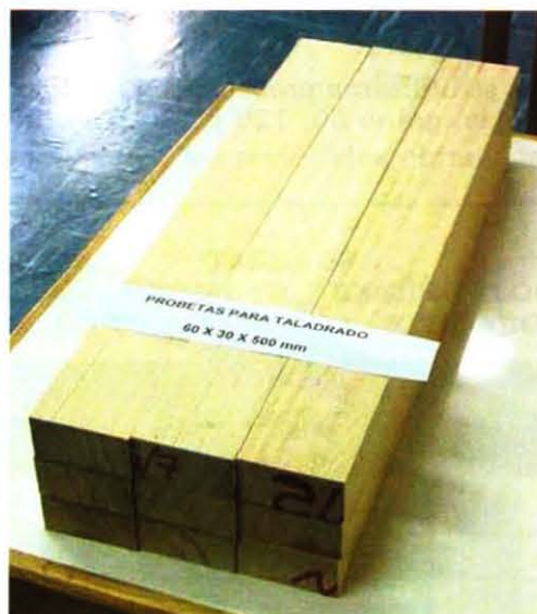
FIGURA 74 DIMENSIONES DE PROBETAS DE TALADRADO
