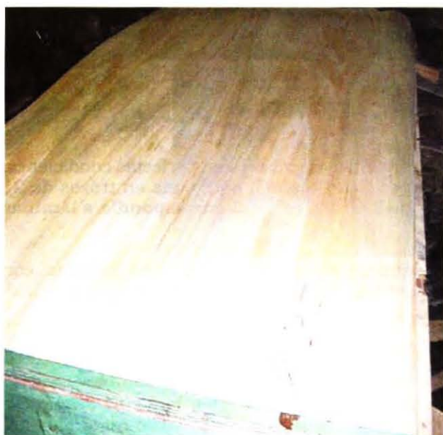
FIGURA 104 LÁMINAS FULL APTAS PARA CARAS DE TABLERO
