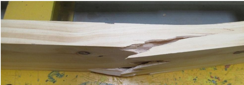
Figura N° 16 FALLA TÍPICA ENSAYO DE CIZALLE PARALELO EN POSICIÓN DE CARA PARA LAMINACIÓN HORIZONTAL
