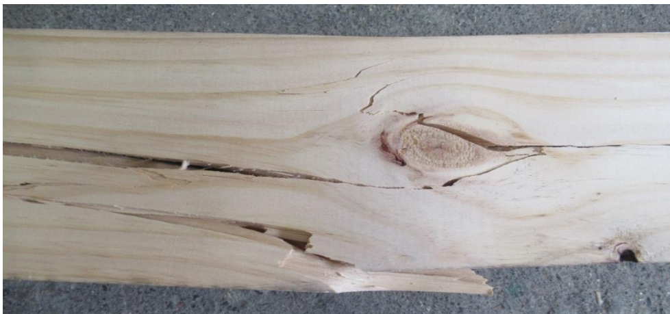
Figura N° 11 FALLA TIPO ENSAYOS DE FLEXIÓN EN POSICIÓN DE CANTO PARA LAMINACIÓN VERTICAL
