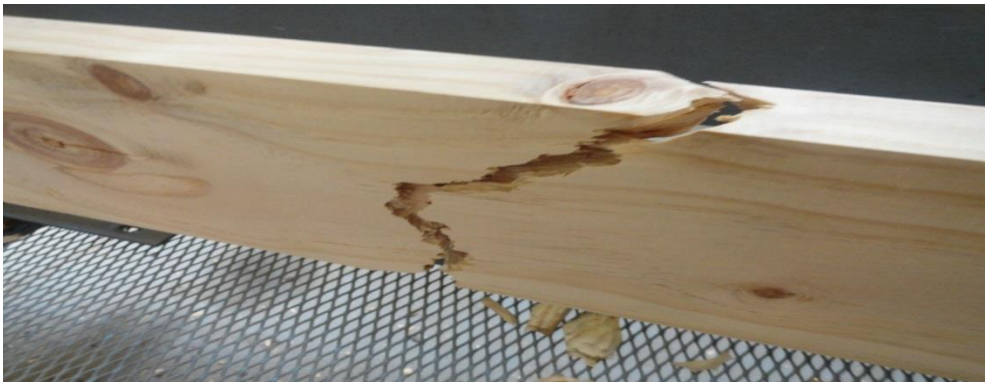
Figura 13 FALLA TIPO ENSAYO DE TRACCIÓN PARALELA A LA FIBRA
