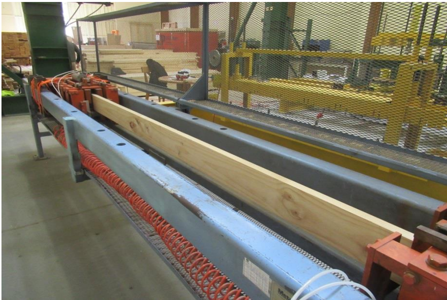
Figura N° 5 APLICACIÓN DE UN ENSAYO DE RESISTENCIA A LA TRACCIÓN PARALELA
