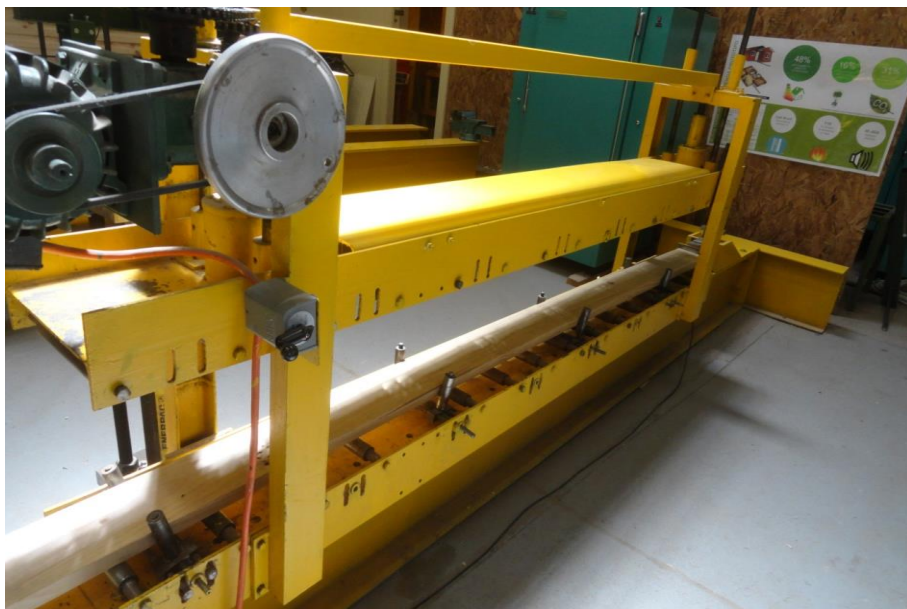
Figura N° 7 APLICACIÓN DE UN ENSAYO DE RESISTENCIA A LA COMPRESIÓN PARALELA
