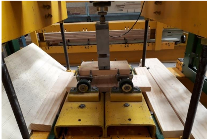
Figura N° 10 APLICACIÓN DE UN ENSAYO DE RESISTENCIA AL CIZALLE PARALELO POSICIÓN DE CARA
