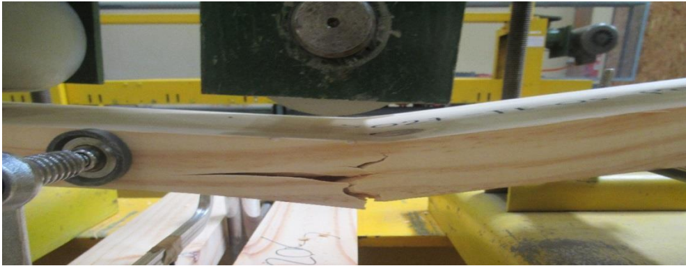
Figura N° 12 FALLA TIPO ENSAYOS DE FLEXIÓN EN POSICIÓN DE CARA PARA LAMINACIÓN HORIZONTAL
