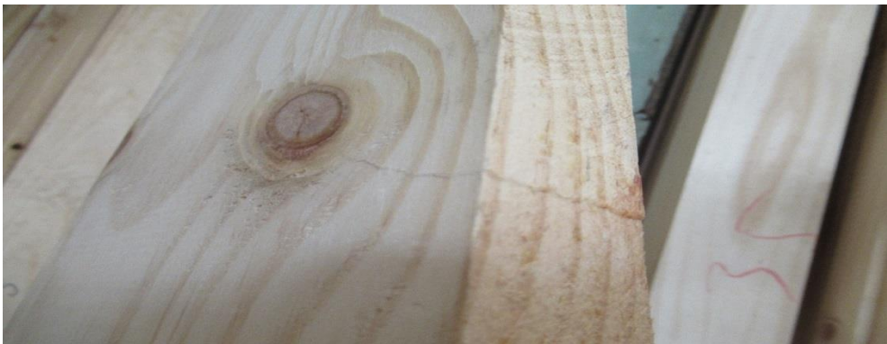
FIGURA N° 14 FALLA TIPO ENSAYO DE COMPRESIÓN PARALELA A LAS FIBRAS
