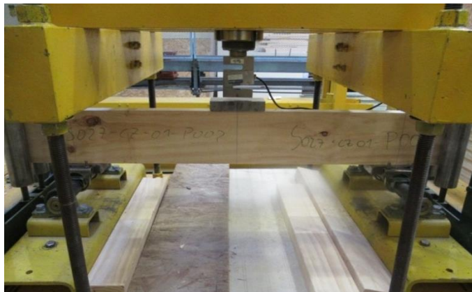
Figura N° 9 APLICACIÓN DE UN ENSAYO DE RESISTENCIA AL CIZALLE PARALELO POSICIÓN DE CANTO
