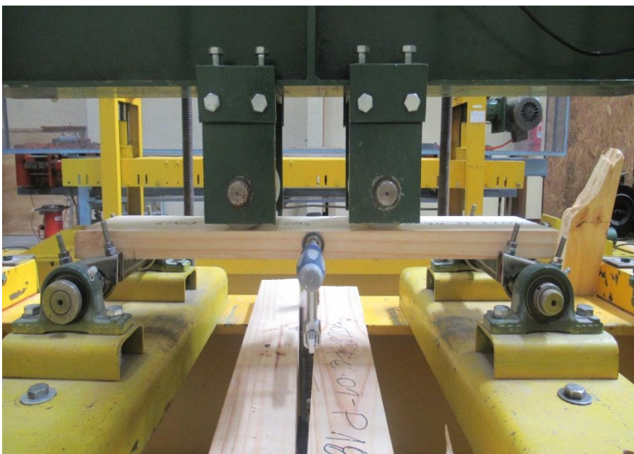
Figura N° 3 APLICACIÓN DEL ENSAYO DE RESISTENCIA Y RIGIDEZ EN FLEXIÓN POSICIÓN DE CARA
