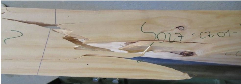
Figura N° 15 FALLA TÍPICA ENSAYO DE CIZALLE PARALELO EN POSICIÓN DE CANTO PARA LAMINACIÓN VERTICAL
