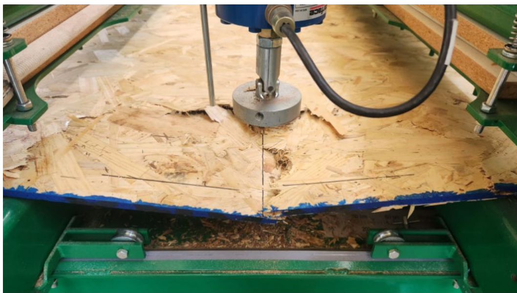
Figura N°15: Probeta ensayada en Carga estática concentrada con impacto, registro de espesor en zona de rotura. LME – INFOR.
