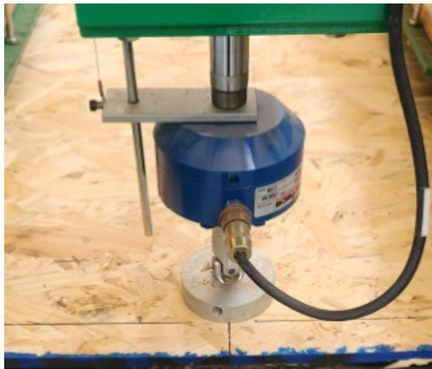
Figura N°13: Carga de calibración de máquina de ensayos para Carga estática concentrada y Carga estática concentrada con impacto. LME – INFOR.
