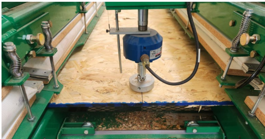
Figura N°14: Ensayo de Carga estática concentrada. LME – INFOR.
