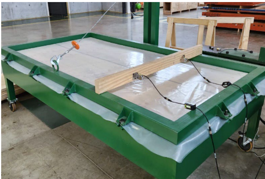
Figura N°7. Implementación del ensayo a carga uniforme
