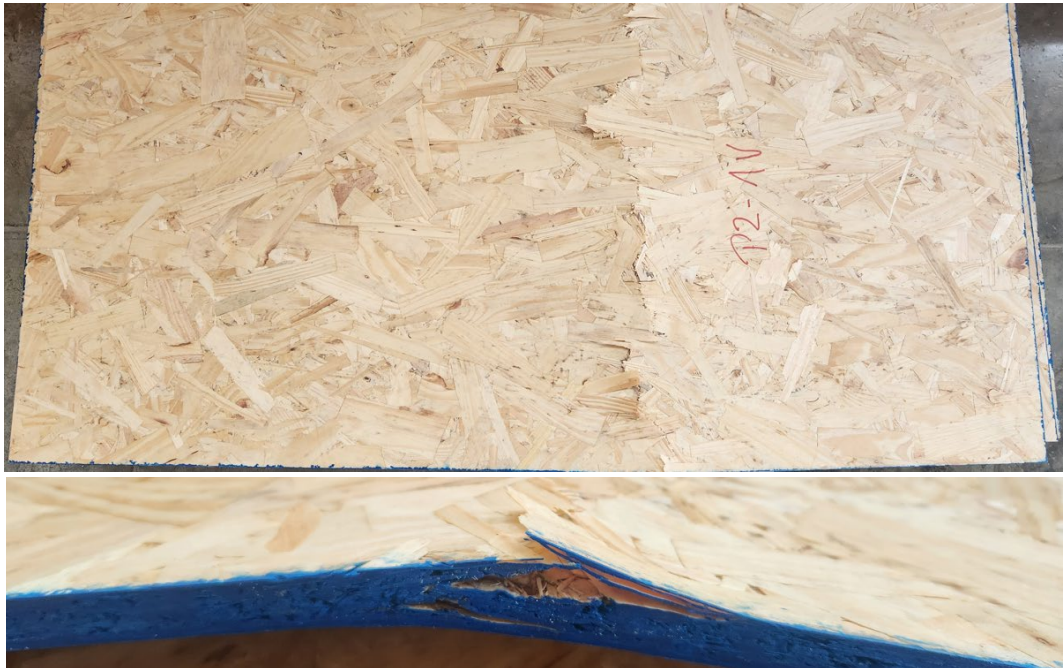
Figura N°12: Probeta horizontal. Imagen superior y lateral de falla paralela a la orientación del eje resistente. LME – INFOR.
