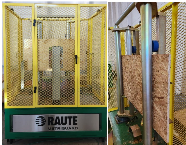
Figura N°3. Implementación del ensayo en flexión
