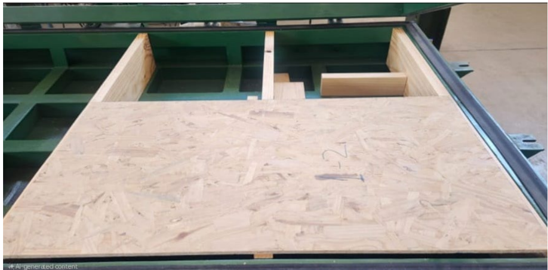
Figura N°16: Preparación de apoyos para ensayo y zona de medición para claro/luz 24. LME – INFOR
