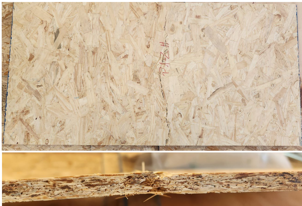
Figura N°11: Probeta longitudinal. Imagen superior y lateral de falla perpendicular a la orientación del eje resistente. LME – INFOR.
