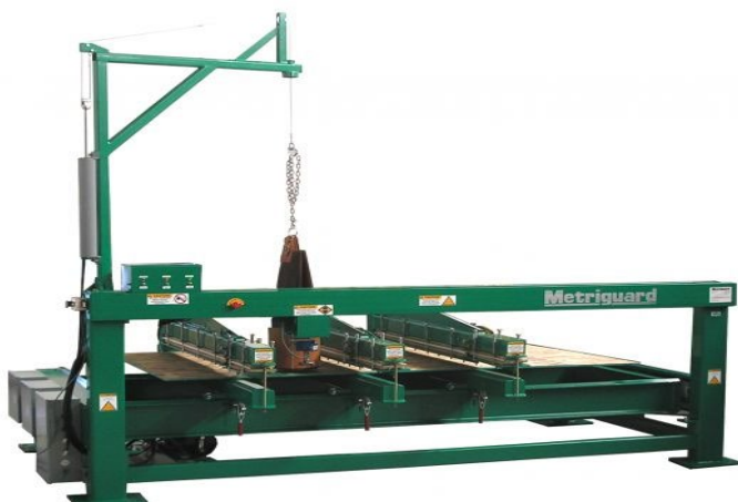
Figura N°5. Implementación ensayos de carga estática concentrada y carga concentrada con impacto
