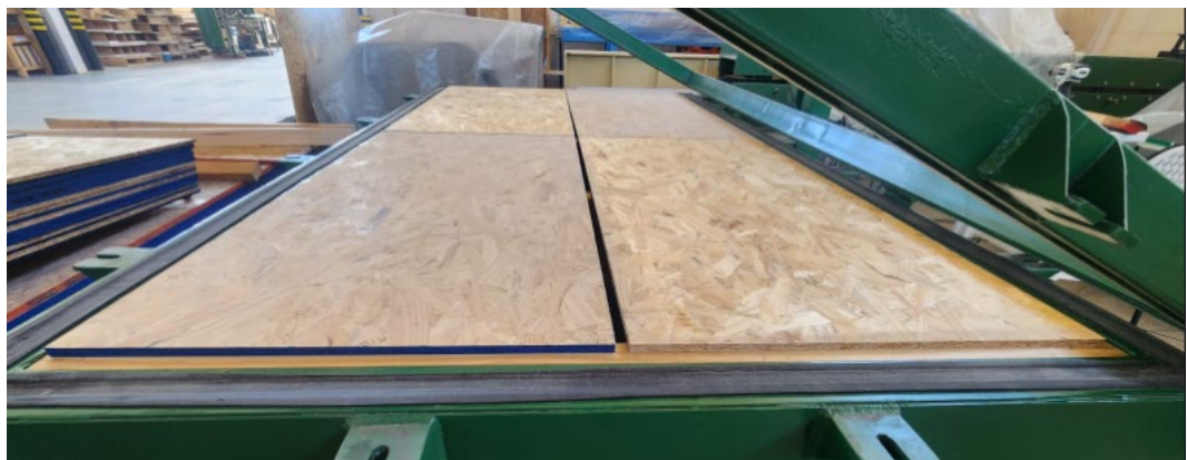
Figura N°17: Preparación de apoyos para ensayo y zona de medición para claro/luz 24. LME – INFOR
