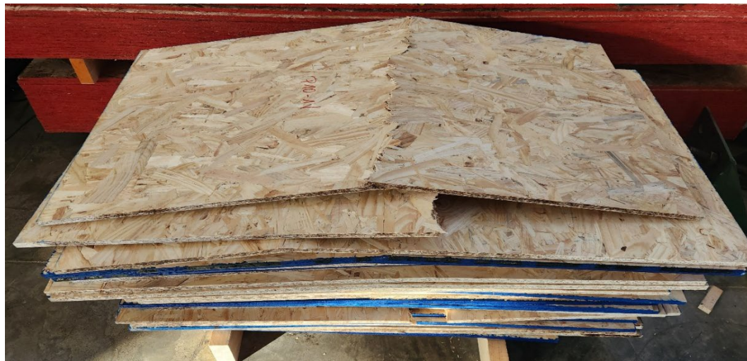
Figura N°9: Probeta longitudinal ensayada, falla perpendicular a la orientación del eje resistente. LME – INFOR
