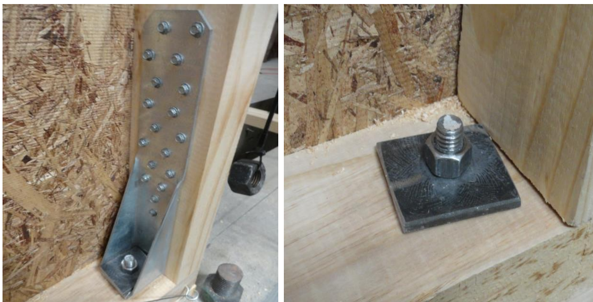
Figura 1.3: Conector utilizado en el sistema de anclaje de los muros de madera ensayados.
