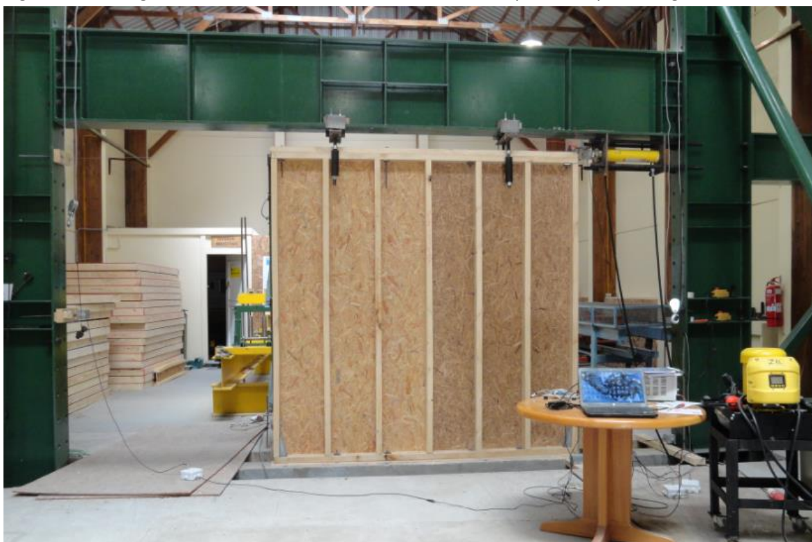
Figura 1.2: Configuración de muro de madera en doble ancho para ensayo de carga horizontal.
