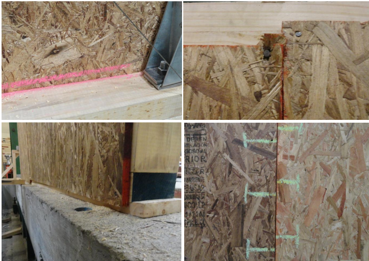
Figura 2.11: Modo de falla característico de ensayo de carga horizontal en muros con estructura de madera de doble ancho.
