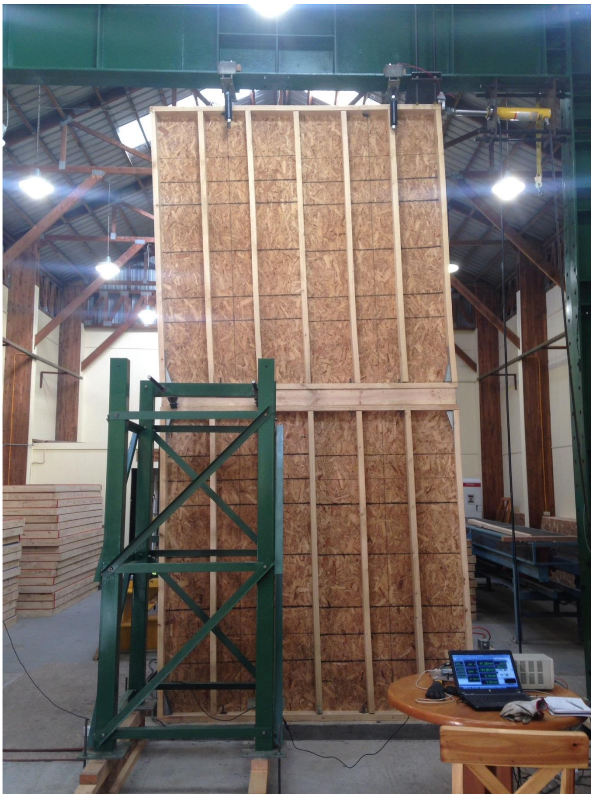
Figura 2.6: Desangulación observada de ensayo de carga horizontal en muros con estructura de madera de doble altura.
