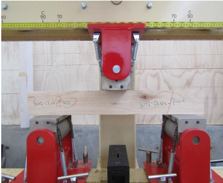
Figura N° 8 IMPLEMENTACIÓN DEL ENSAYO AL CIZALLE
