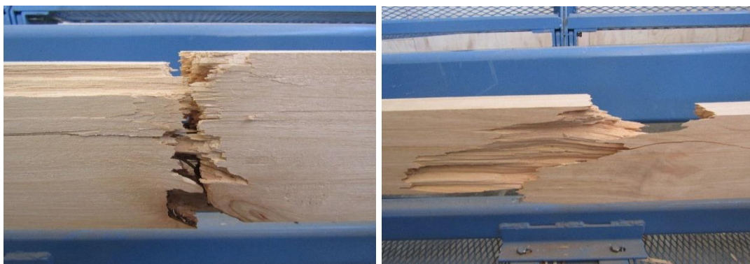
Figura N° 13 FALLAS TÍPICAS EN EL ENSAYO A LA TRACCIÓN
