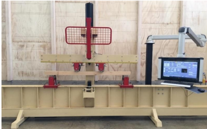
Figura N° 2 IMPLEMENTACIÓN DEL ENSAYO DE FLEXIÓN
