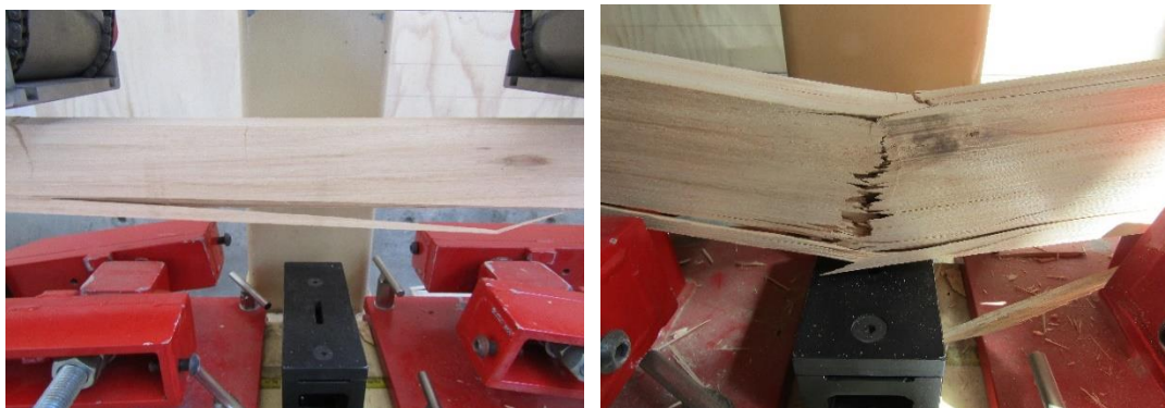
Figura N°12 FALLAS TÍPICAS EN EL ENSAYO A LA FLEXIÓN
