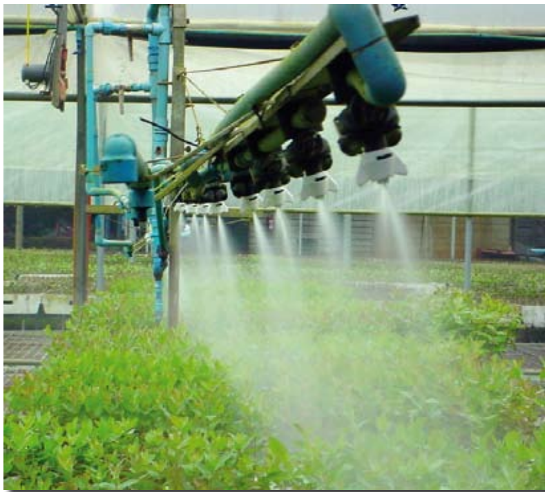
Figura 5.1. Sistema de riego de carro.
