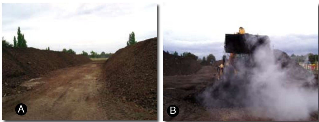
Figura 1.17. Pilas de corteza de pino radiata fresca (A); proceso de volteo de corteza una vez que ha logrado la temperatura adecuada en la pila (B).
