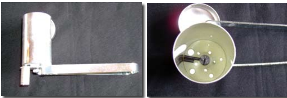
Figura 2.4. Vista exterior de una sembradora manual y detalle de sus unidades dosificadoras ubicadas en la base del recipiente de semillas.
