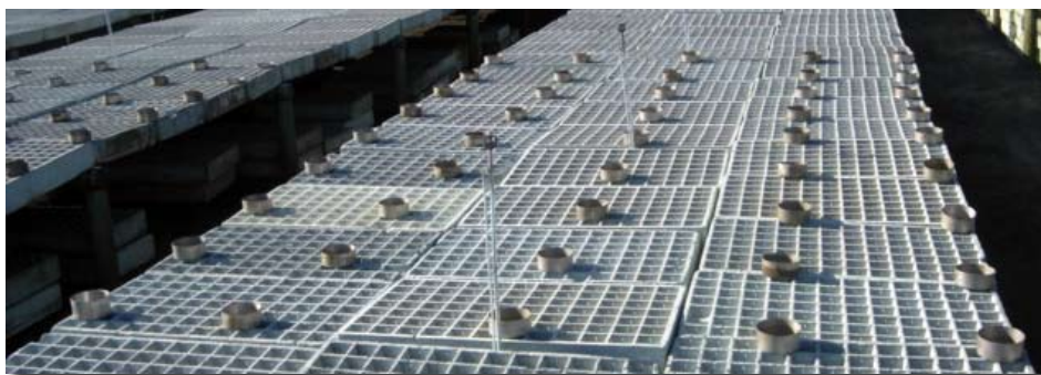
Figura 5.3. Disposición de receptáculos, sobre las bandejas para la determinación de la uniformidad del riego en mesones de cultivo.
