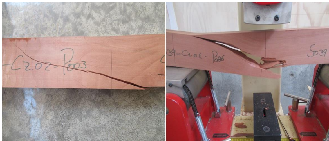
Figura N° 15 FALLAS TÍPICAS EN EL ENSAYO AL CIZALLE PARALELO
