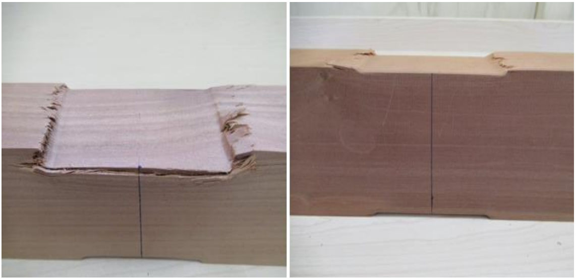
Figura N°16 FALLA TÍPICA DEL ENSAYO A LA COMPRESIÓN NORMAL
