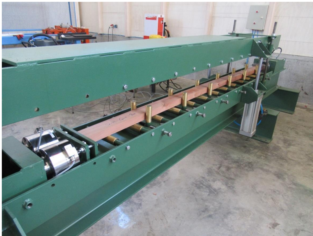
Figura N° 6 IMPLEMENTACIÓN DEL ENSAYO A LA COMPRESIÓN PARALELA
