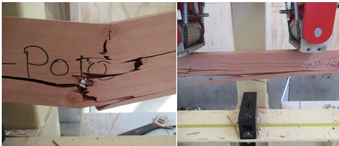
Figura N° 12 FALLAS TÍPICAS EN EL ENSAYO A LA FLEXIÓN
