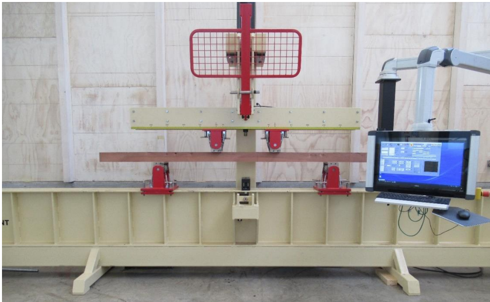
Figura N° 2 IMPLEMENTACIÓN DEL ENSAYO DE FLEXIÓN
