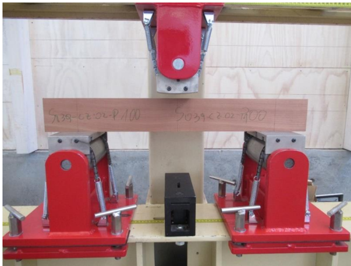
Figura N° 8 IMPLEMENTACIÓN DEL ENSAYO AL CIZALLE
