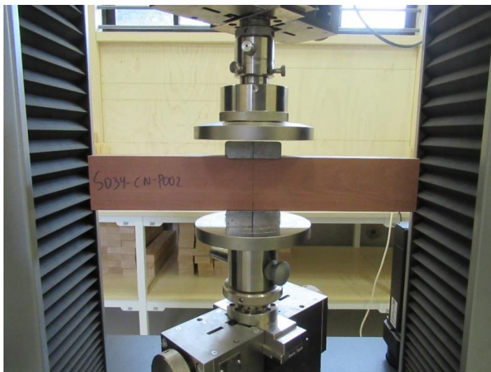
Figura N° 10 IMPLEMENTACIÓN DEL ENSAYO A LA COMPRESIÓN NORMAL
