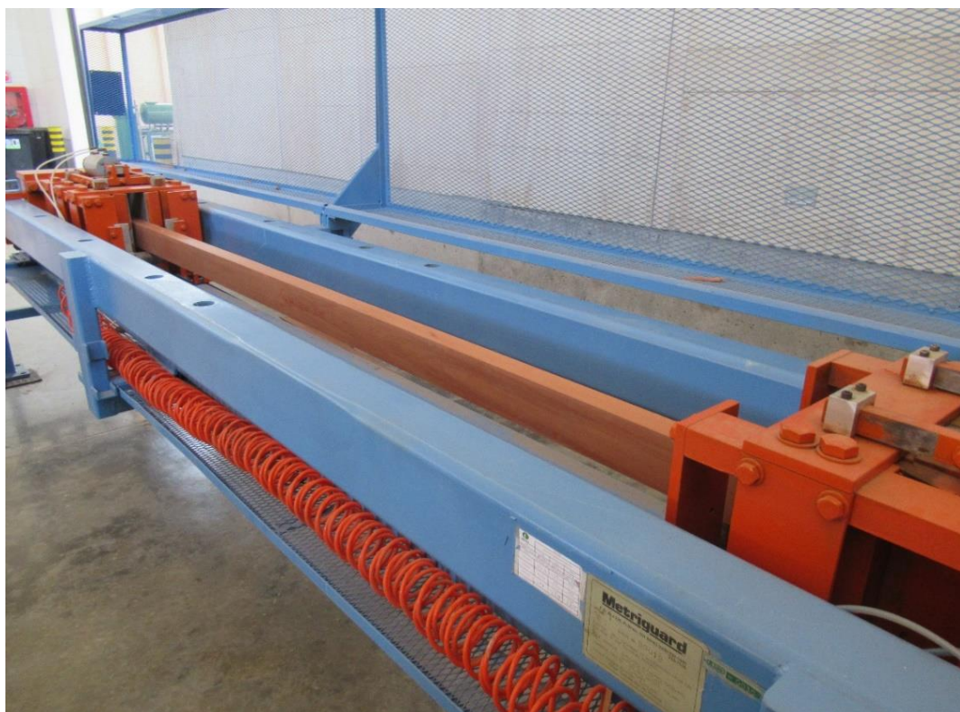
Figura N° 4 IMPLEMENTACIÓN DEL ENSAYO A LA TRACCIÓN PARALELA
