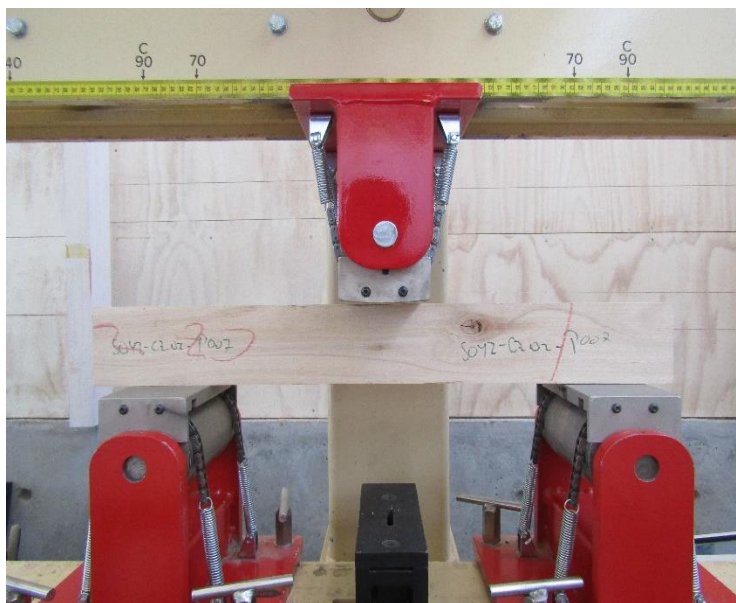
Figura N° 8 IMPLEMENTACIÓN DEL ENSAYO AL CIZALLE
