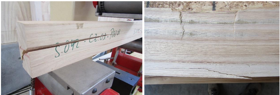
Figura N° 15 FALLAS TÍPICAS EN EL ENSAYO AL CIZALLE PARALELO
