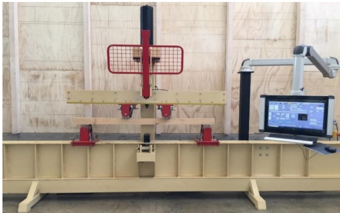
Figura N° 2 IMPLEMENTACIÓN DEL ENSAYO DE FLEXIÓN
