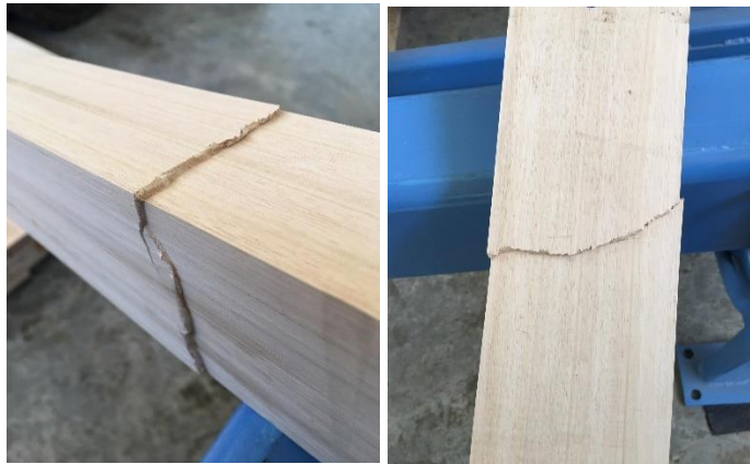
Figura N° 14 FALLAS TÍPICAS EN EL ENSAYO A LA COMPRESIÓN PARALELA
