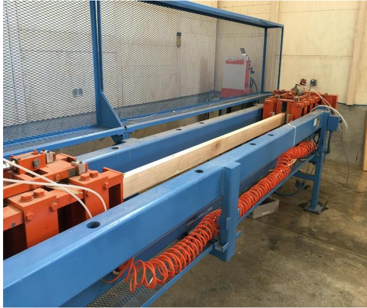
Figura N° 4 IMPLEMENTACIÓN DEL ENSAYO A LA TRACCIÓN PARALELA
