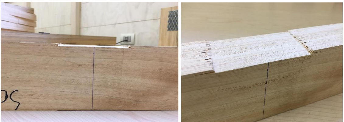
Figura N° 16 FALLA TÍPICA DEL ENSAYO A LA COMPRESIÓN NORMAL
