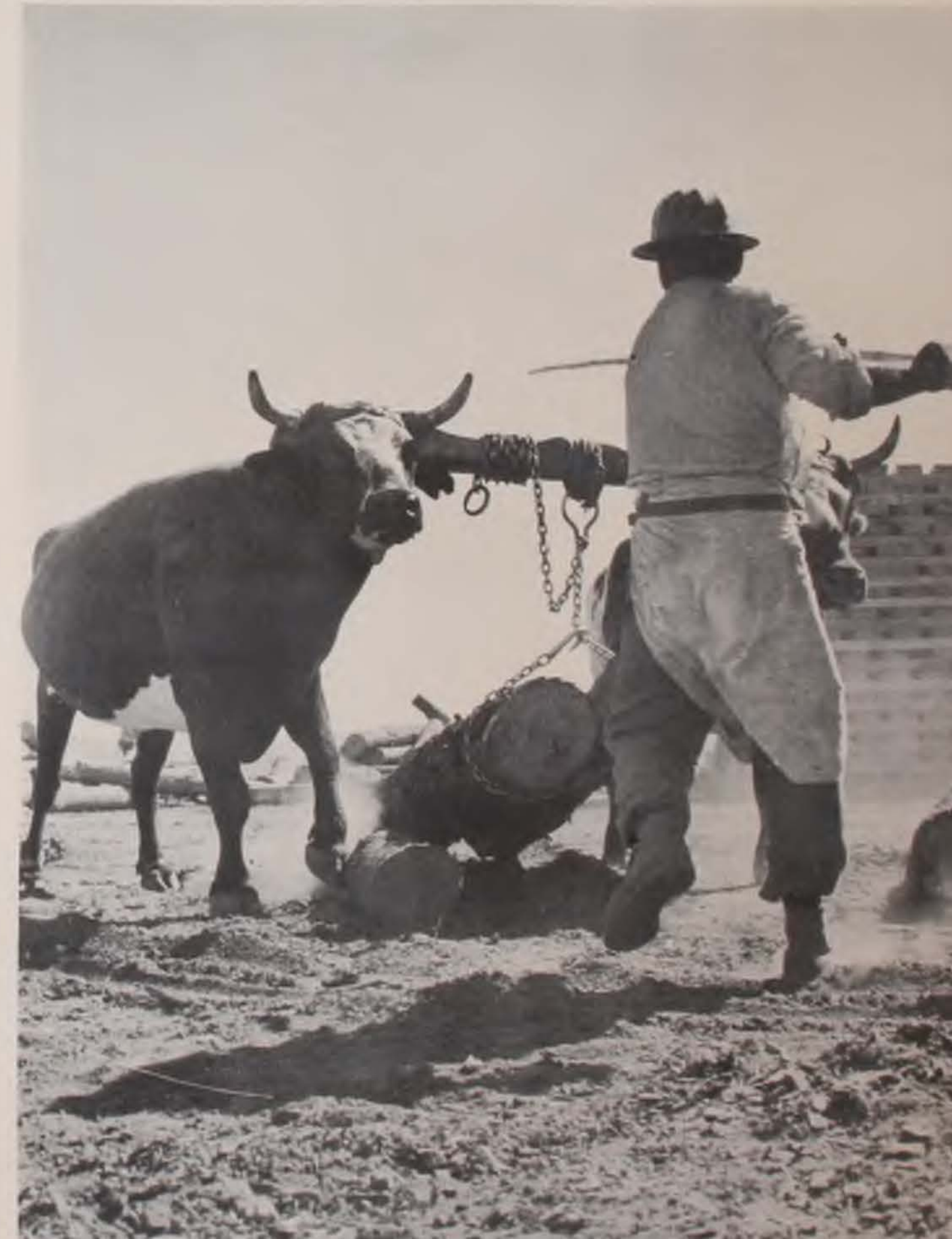
Alimentación de trozas al aserradero de sierra circular mediante el empleo de bueyes.
