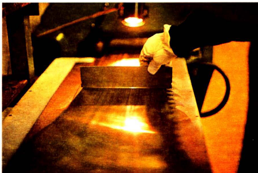
Figura 24. CAVIDAD BAJO UNA REGLA RECTA MOSTRADA POR UNA HOJA DE SIERRA QUE TIENE TENSIÓN.
