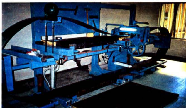
Figura 5. BANCO TENSIONADOR PROVISTO DE DOS YUNQUES EMPAREJADORES, APTO PARA SIERRAS DE GRAN TAMAÑO.
