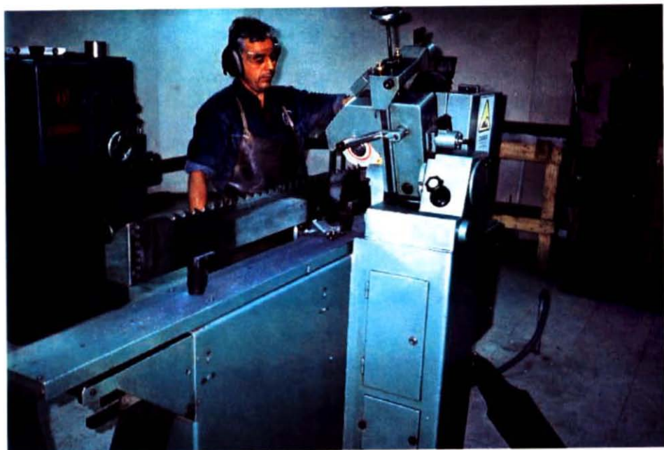
Figura 54. PARA OPERAR MÁQUINAS AFILADORAS ES INDISPENSABLE EL USO DE PROTECTORES PARA LOS OJOS Y OÍDOS.
