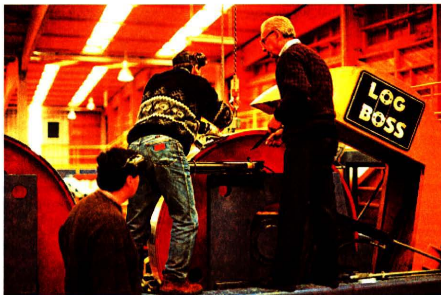
Figura 45. LA CARA DE LOS VOLANTES ES DETERMINANTE PARA EL DESEMPEÑO DE LA SIERRA (su estado debe comprobarse con frecuencia)
