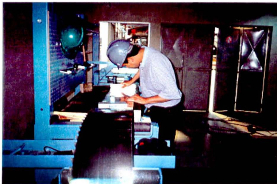
Figura 17. DETECTANDO PROTUBERANCIAS LONGITUDINALES EN LA CARA EXTERNA DE LA SIERRA.
