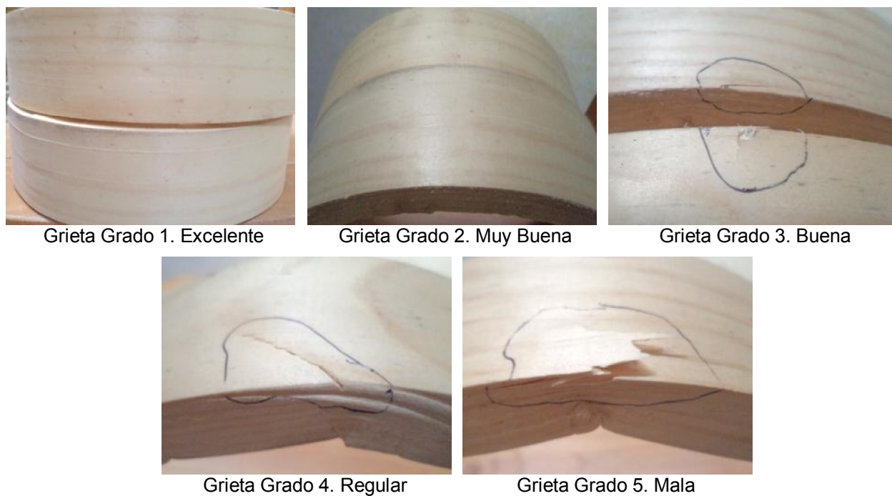
Figura N° 47. Grados de Calidad para Grietas
