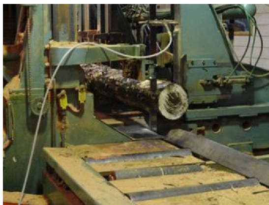
Figura N° 3. Destape de la Troza
