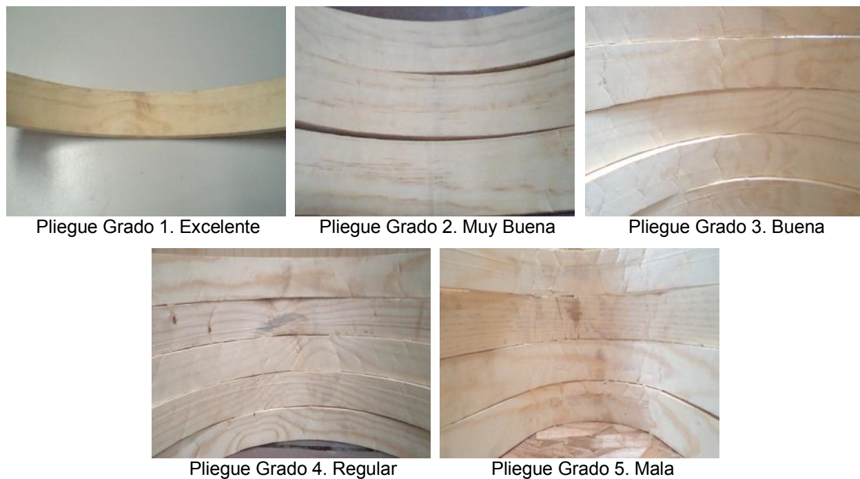
Figura N° 46. Grados de Calidad para Pliegues
