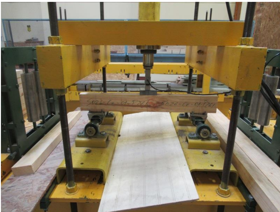
Figura N° 8 APLICACIÓN DEL ENSAYO DE RESISTENCIA AL CIZALLE PARALELO SEGÚN NCh 3028/1
