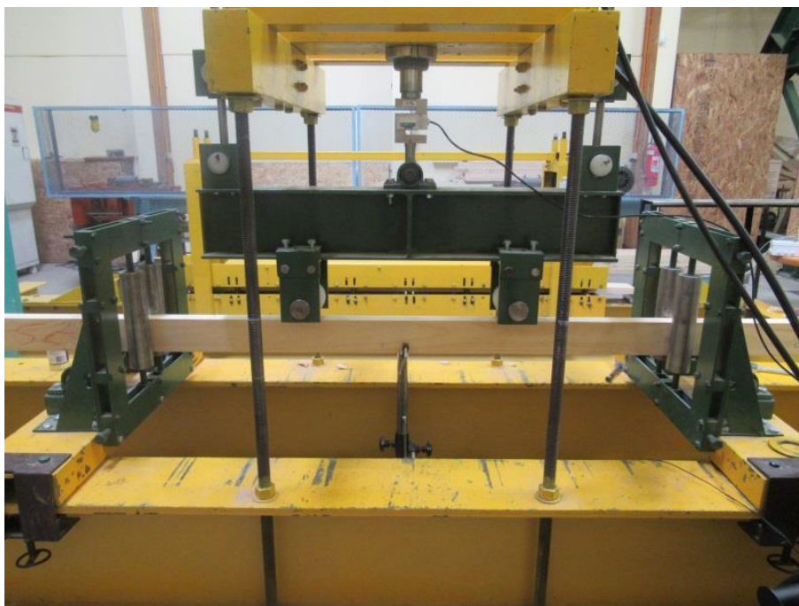
Figura N° 2 APLICACIÓN DEL ENSAYO DE RESISTENCIA Y RIGIDEZ EN FLEXIÓN SEGÚN NCh 3028/1
