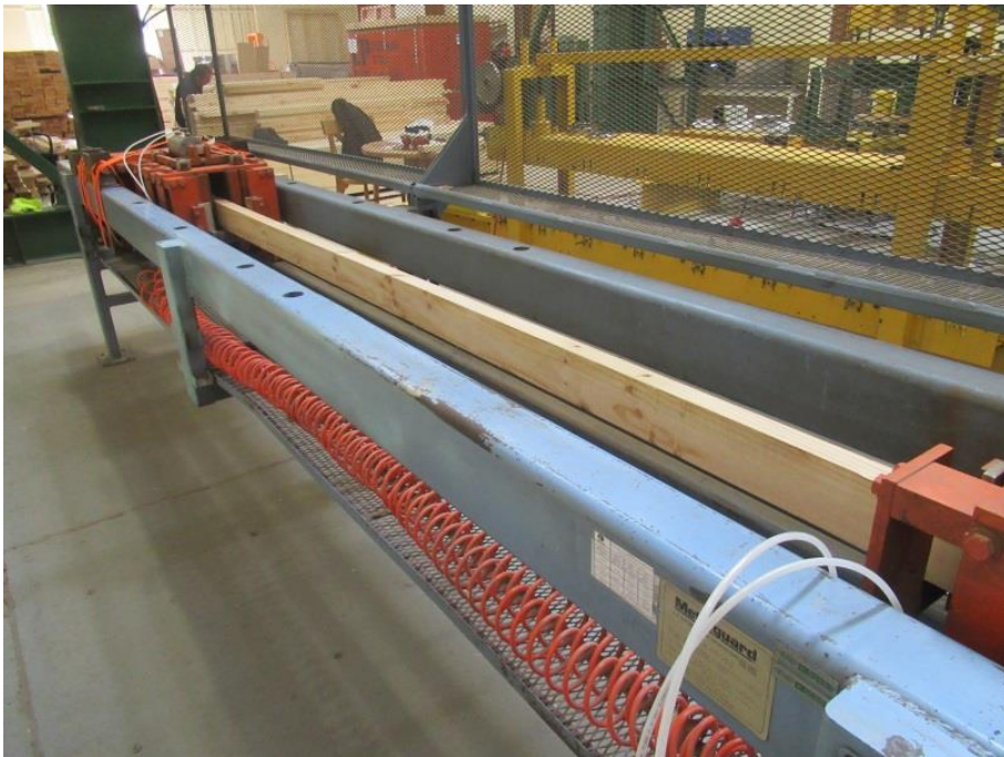
Figura N° 4 APLICACI3N DEL ENSAYO DE RESISTENCIA A LA TRACCI3N PARALELA SEG3N NCh 3028/1
