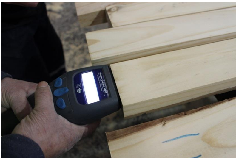
Figura N° 11 EQUIPO MTG PARA CLASIFICACIÓN ESTRUCTURAL MECÁNICA GRADOS C16 Y C24
