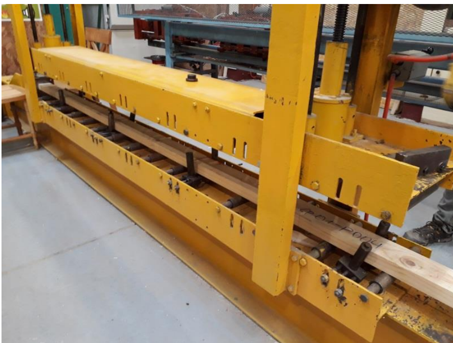
Figura N° 6 APLICACIÓN DEL ENSAYO DE RESISTENCIA A LA COMPRESIÓN PARALELA SEGÚN NCh 3028/1
