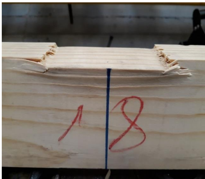
Figura N° 18 FALLA ENSAYOS DE COMPRESIÓN NORMAL A LA FIBRA
