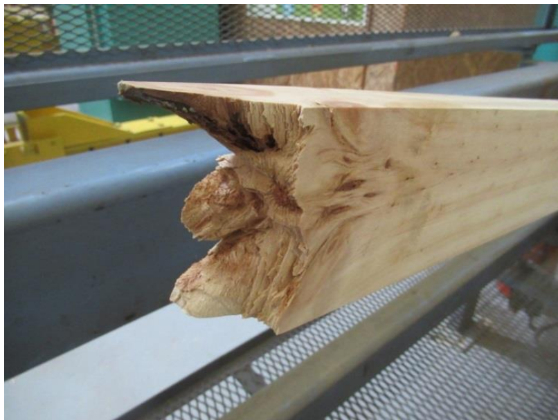
Figura N° 15 FALLA ENSAYO DE TRACCIÓN PARALELA
