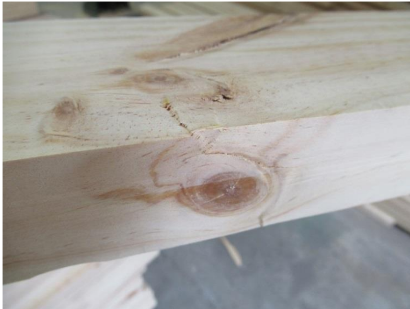
Figura N° 16 FALLA ENSAYO DE COMPRESIÓN PARALELA
