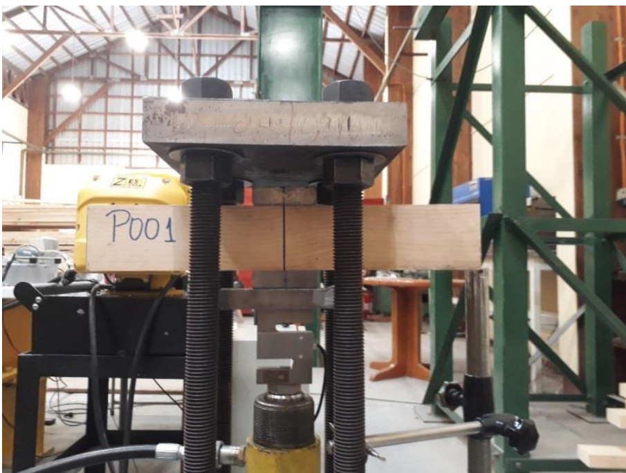
Figura N° 10 APLICACIÓN DEL ENSAYO DE COMPRESIÓN NORMAL A LA FIBRA SEGÚN NCh 3028/1
