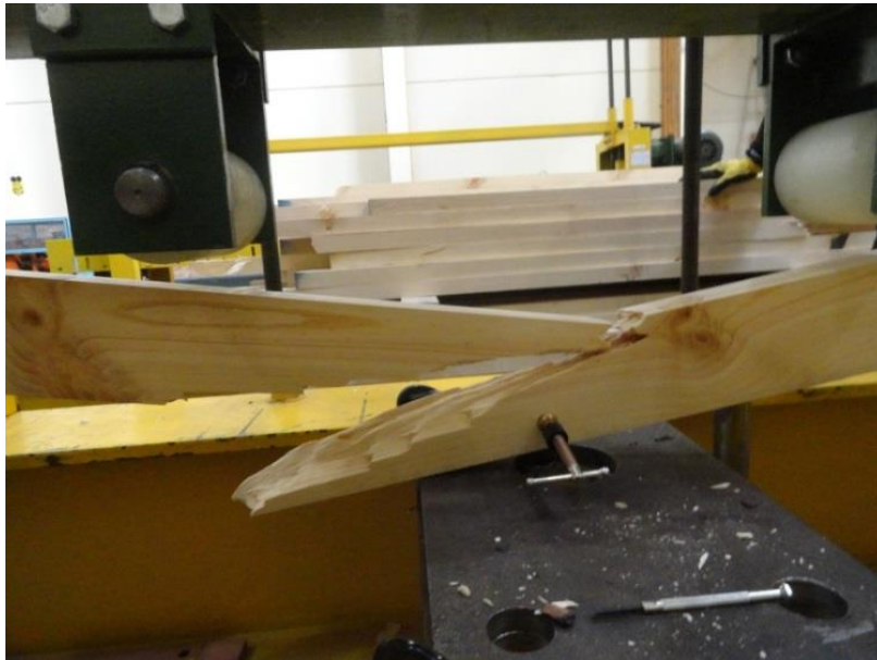
Figura N° 14 FALLA ENSAYO DE FLEXIÓN
