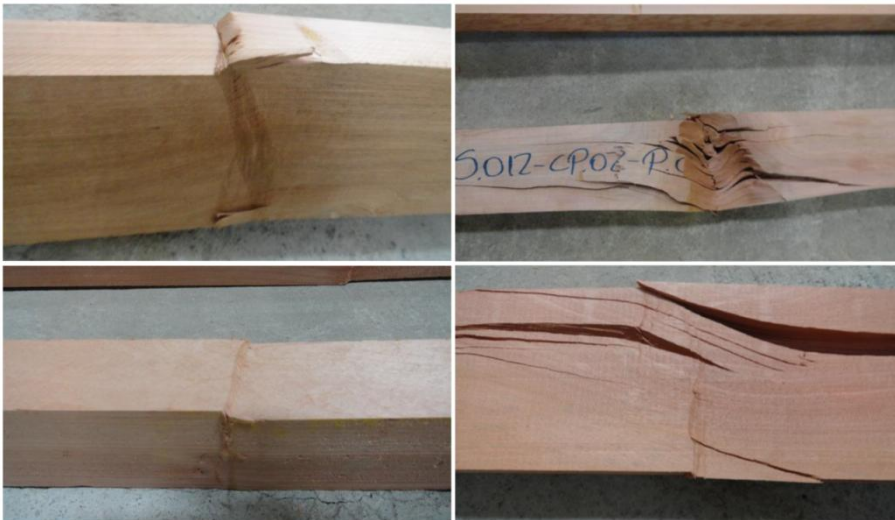
Figura N° 16 FALLAS POR COMPRESIÓN PARALELA
