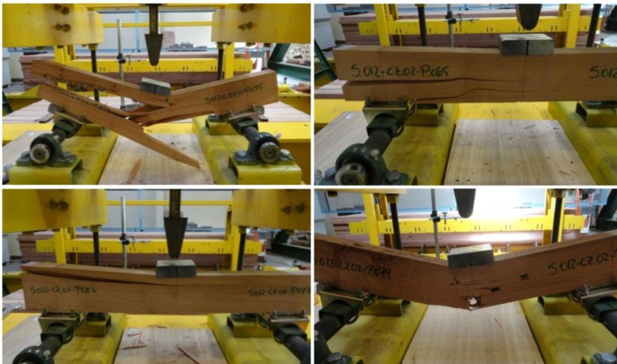
Figura N° 17 FALLAS POR CIZALLE PARALELO
