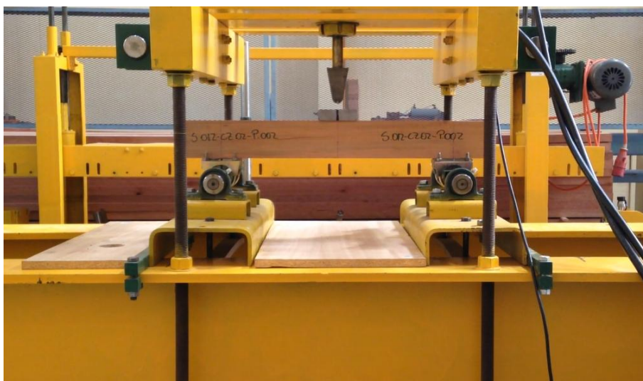
Figura N° 8 APLICACIÓN DE UN ENSAYO DE RESISTENCIA AL CIZALLE PARALELO A LAS FIBRAS
