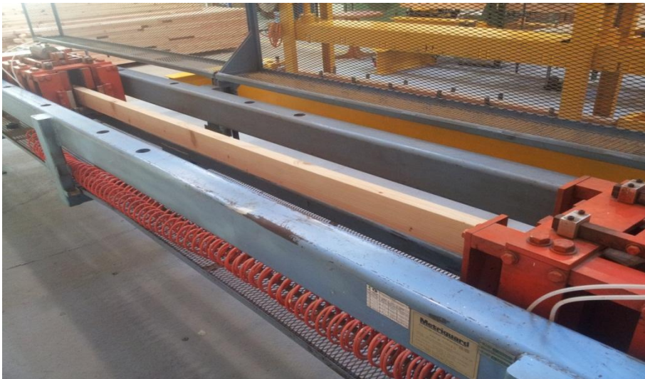
Figura N°4 APLICACIÓN DE UN ENSAYO DE RESISTENCIA A LA TRACCIÓN PARALELA A LAS FIBRAS
