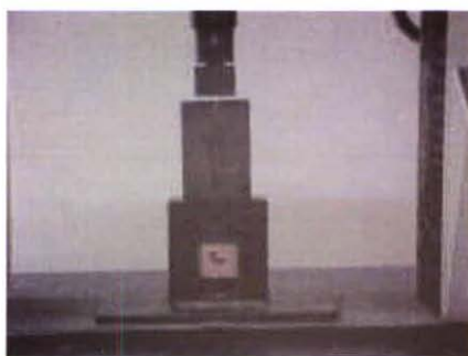
Figura 7: Probetas para ensayo de cizalle, según norma ASTM D 5751
