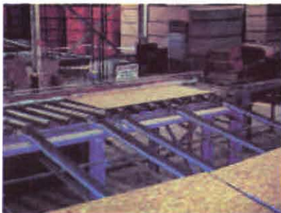
Figura 2: Tablero en proceso de formateado
