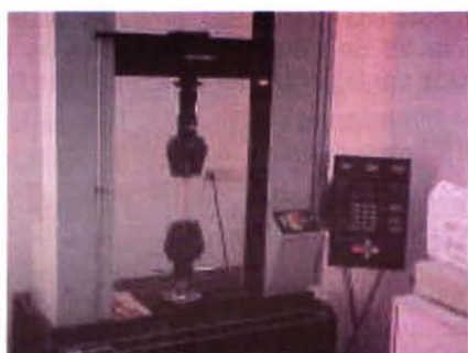
Figura 5: Ensayos de flexión y tracción, según norma ASTM D 5572
