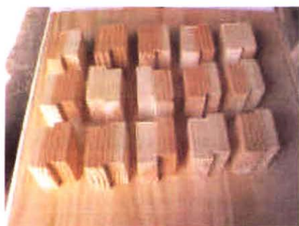
Figura 7: Probetas para ensayo de cizalle, según norma ASTM D 5751
