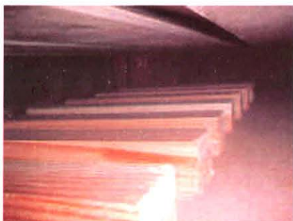
Figura 2: Fabricación de uniones laminares, configuración en prensa
