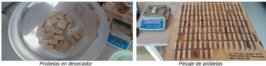
Figura N° 2 PREPARACIÓN DE LAS PROBETAS
