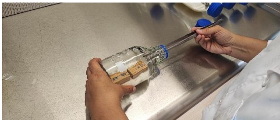
Figura N° 7 MONTAJE DE LAS PROBETAS
